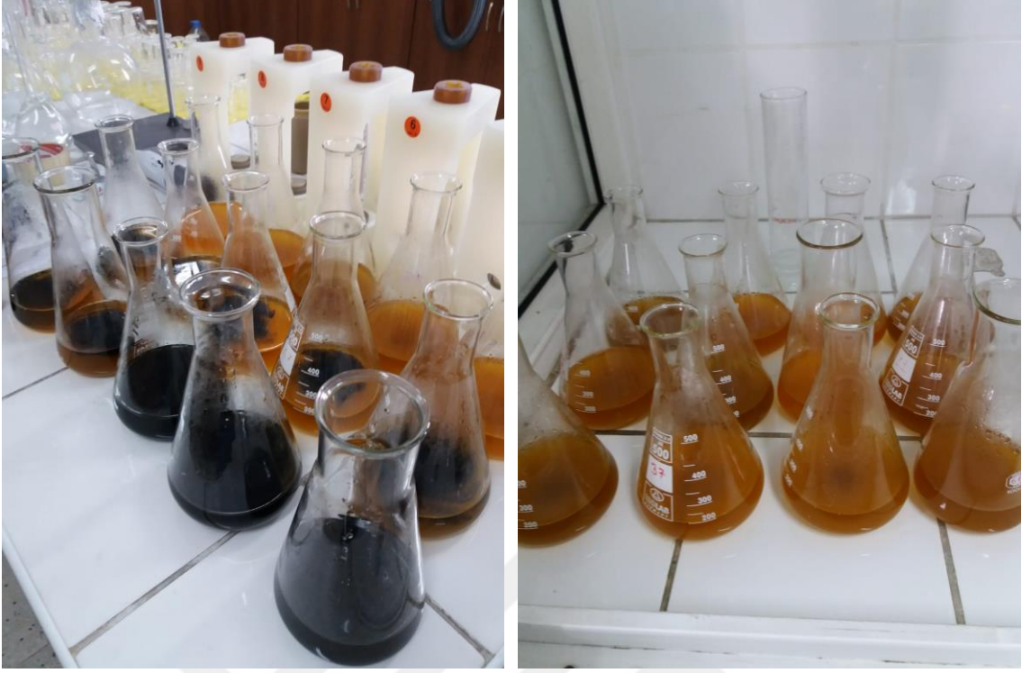
Şekil 11. Walkley-Black ıslak yakma yöntemi ile organik madde tayini
