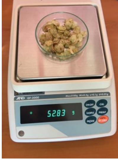
Şekil 4. 1000 tane ağırlığının 0,01 gr hassasiyetli terazi ile ölçülmesi
