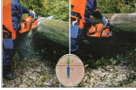
Şekil 30. Boylama işlerinde kesim tekniği (URL-2, 2017).
