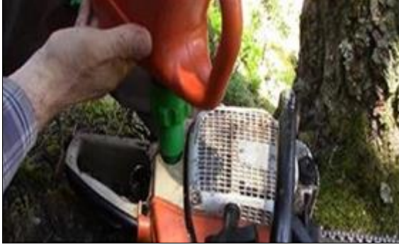
Şekil 5. Motorlu testere yakıt/yağ ikmali ve zincir bakımı
