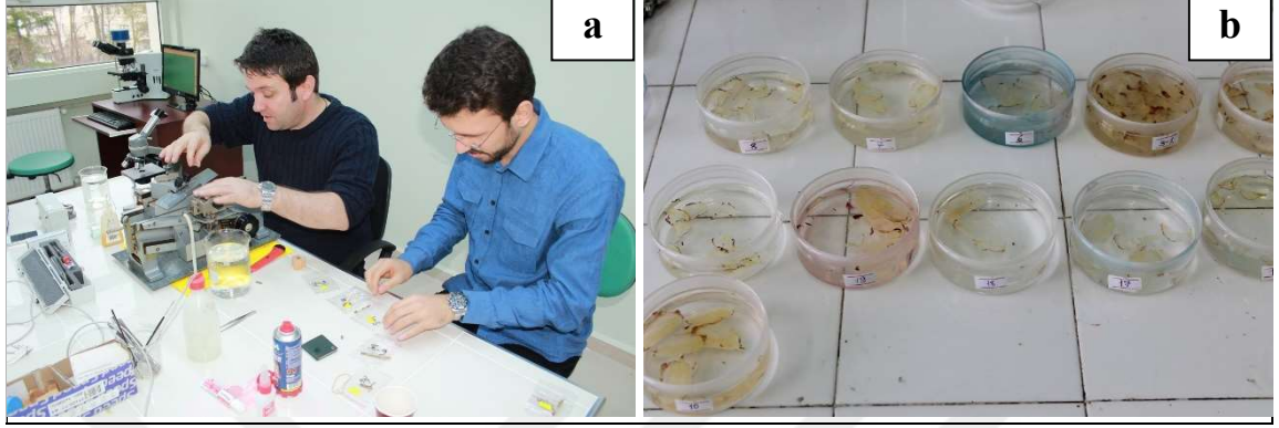
Şekil 5. Örneklerden Reichert kışaklı mikrotomu yardımı ile kesitlerin alınması (a), kesitlerin sodyum hipokloritte saydamlaştırılması işlemi (b)
