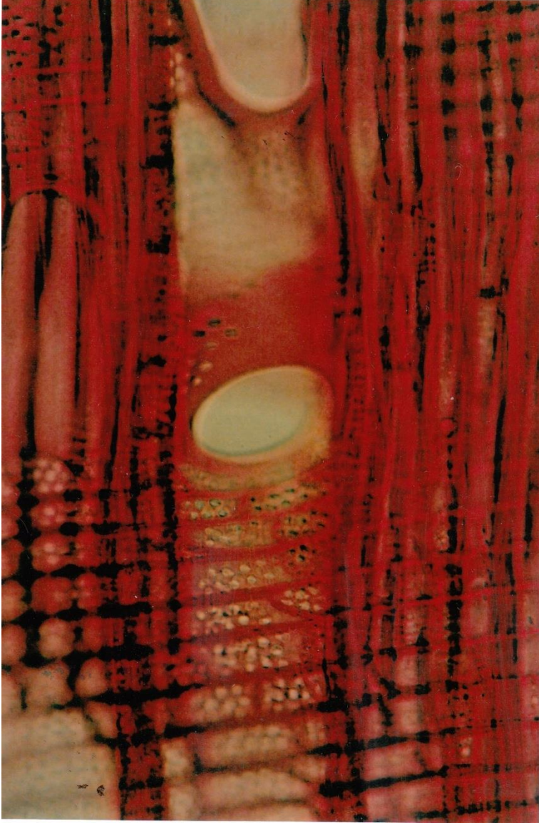
Şekil 17. Pterocarya fraxinifolia (Lam.) Spach. odunundan radyal kesitte basit perforasyon tablası x425
