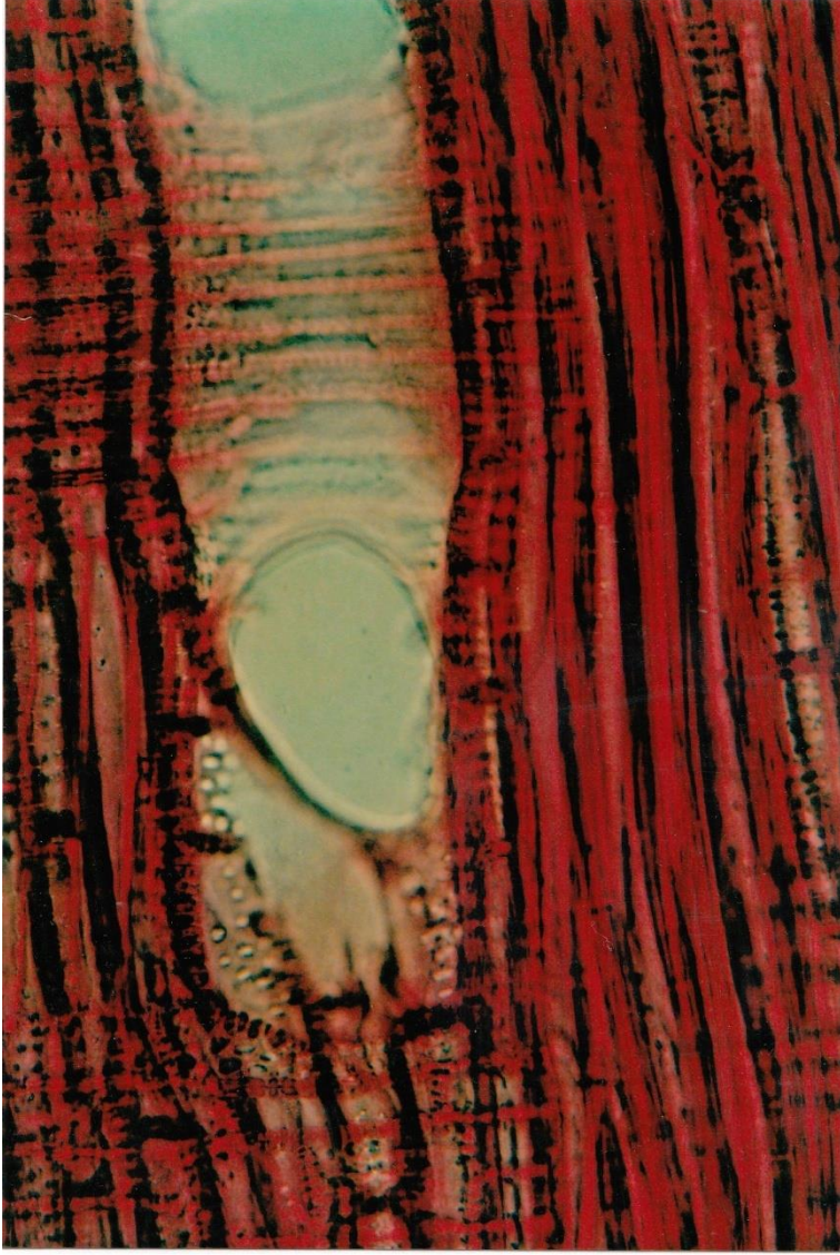
Şekil 7. Juglans regia L. odunundan radyal kesitte basit perforasyon tablası x425
