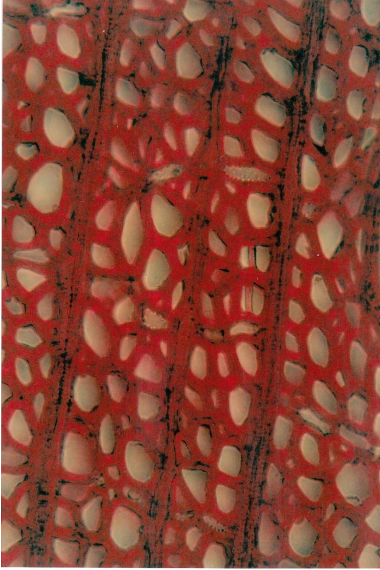
Şekil 13. Pterocarya fraxinifolia (Lam.) Spach. odunundan enine kesitte kesik zincir şeklinde odun paranzimi x425
