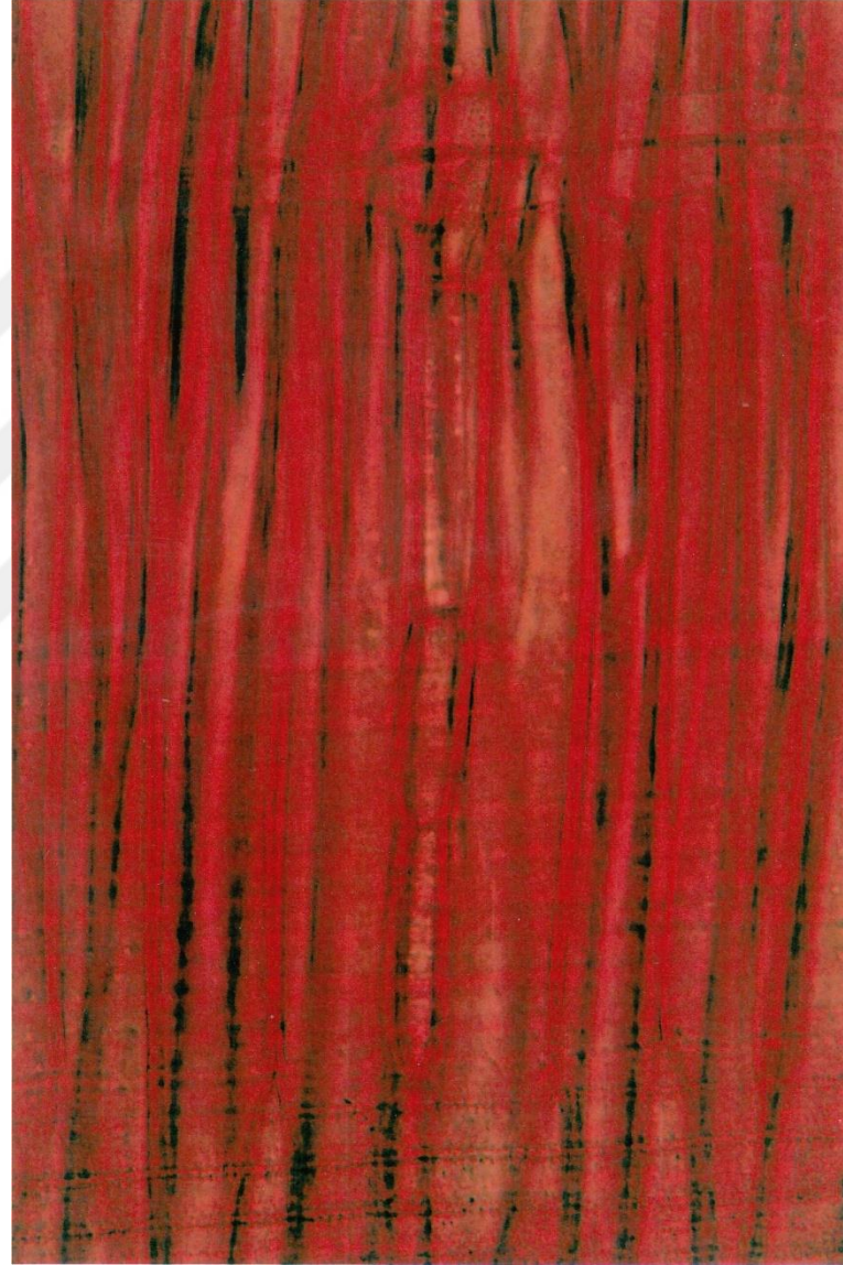
Şekil 16. Pterocarya fraxinifolia (Lam.) Spach. odunundan radyal kesitte odun paraşımı x425
