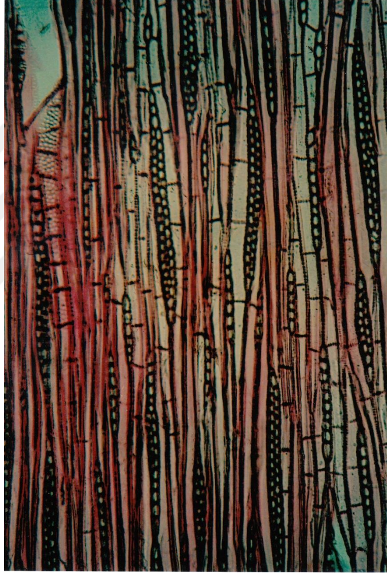
Şekil 18. Pterocarya fraxinifolia (Lam.) Spach. odunundan teğetsel kesitte üniseri multiseri özışınları x170
