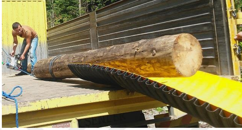
Şekil 25. Tomruğun oluk içerisinde kamyona çekilmesi
