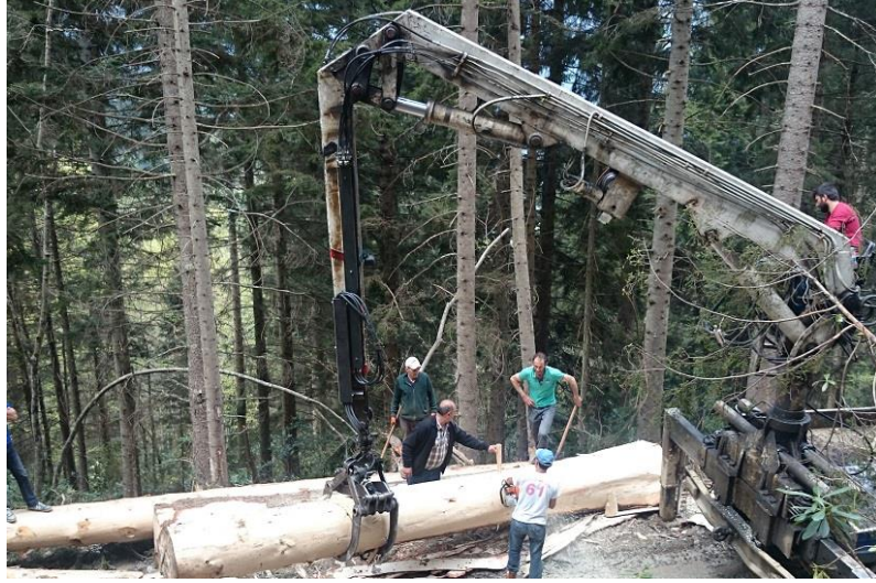
Şekil 21. Yükleyicinin tomruğu kavraması
