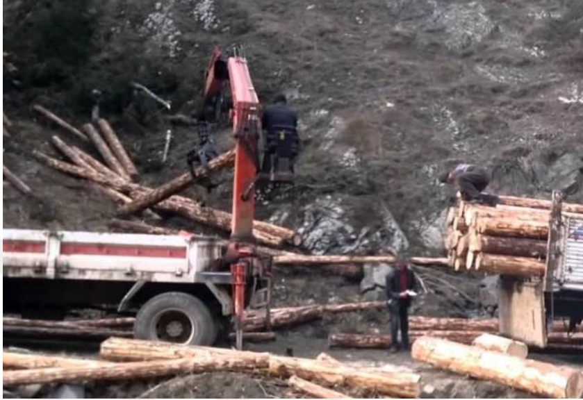
Şekil 5. Taşıma aracına monte edilen vinç ile yükleme (Acar, 2004).
