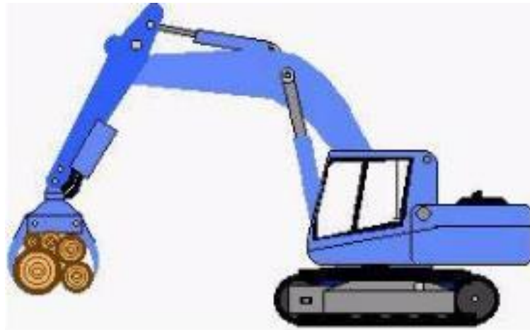
Şekil 6. Hareketli döner kreyin ile yükleme (Acar, 2004).
