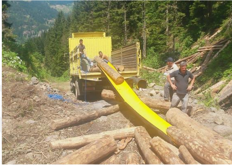
řekil 12. Tařınabilir el vinci ve oluk kombinasyonu ile ykleme
