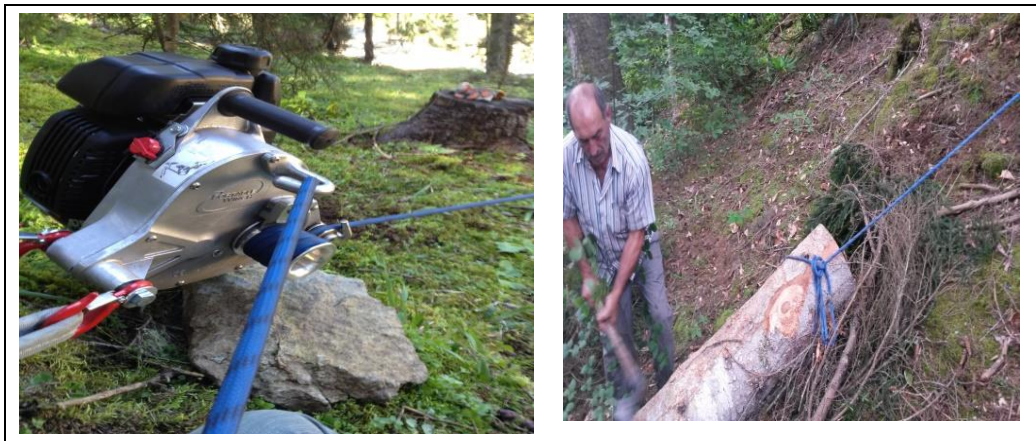
Şekil 11. Taşınabilir el vinci ile doğal arazide tomruk çekimi
