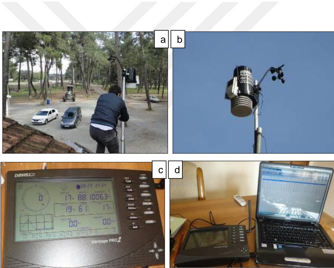
Şekil 13. Trabzon ili mobil meteoroloji istasyonlarının kurulması (a) ve ölçüm zamanlarına ilişkin hava hallerinin kaydedilip anlık olarak bilgisayara aktarılması (b)
