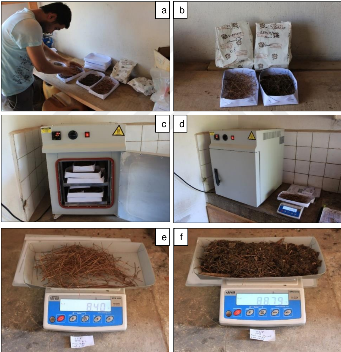
Şekil 30. Arazi örneklerinin kurutma kaplarına alınarak (a, b) fırınlara yerleştirilmesi (c, d) ve kurutulan örneklerin fırın kurusu ağırlıklarının belirlenmesi (e, f)
