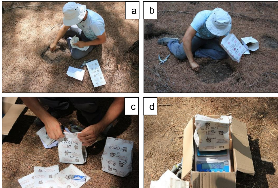
Şekil 24. İYM ve humus nem örneklerinin alınarak kese kâğıtlarına yerleştirilmesi (a, b) ve ölçüm zamanlarında arazi ağırlıklarının hassas terazi ile belirlenmesi (c, d)
