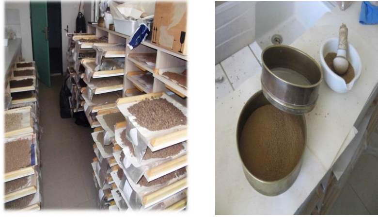
Şekil 5. Toprak kurutma ve öğütme aşaması
