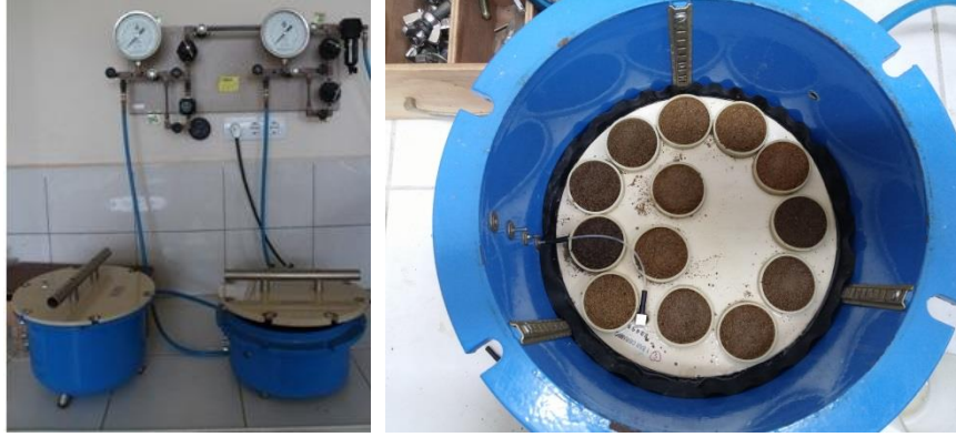
Şekil 8. Tarla kapasitesi ve solma noktası ölçümleri
