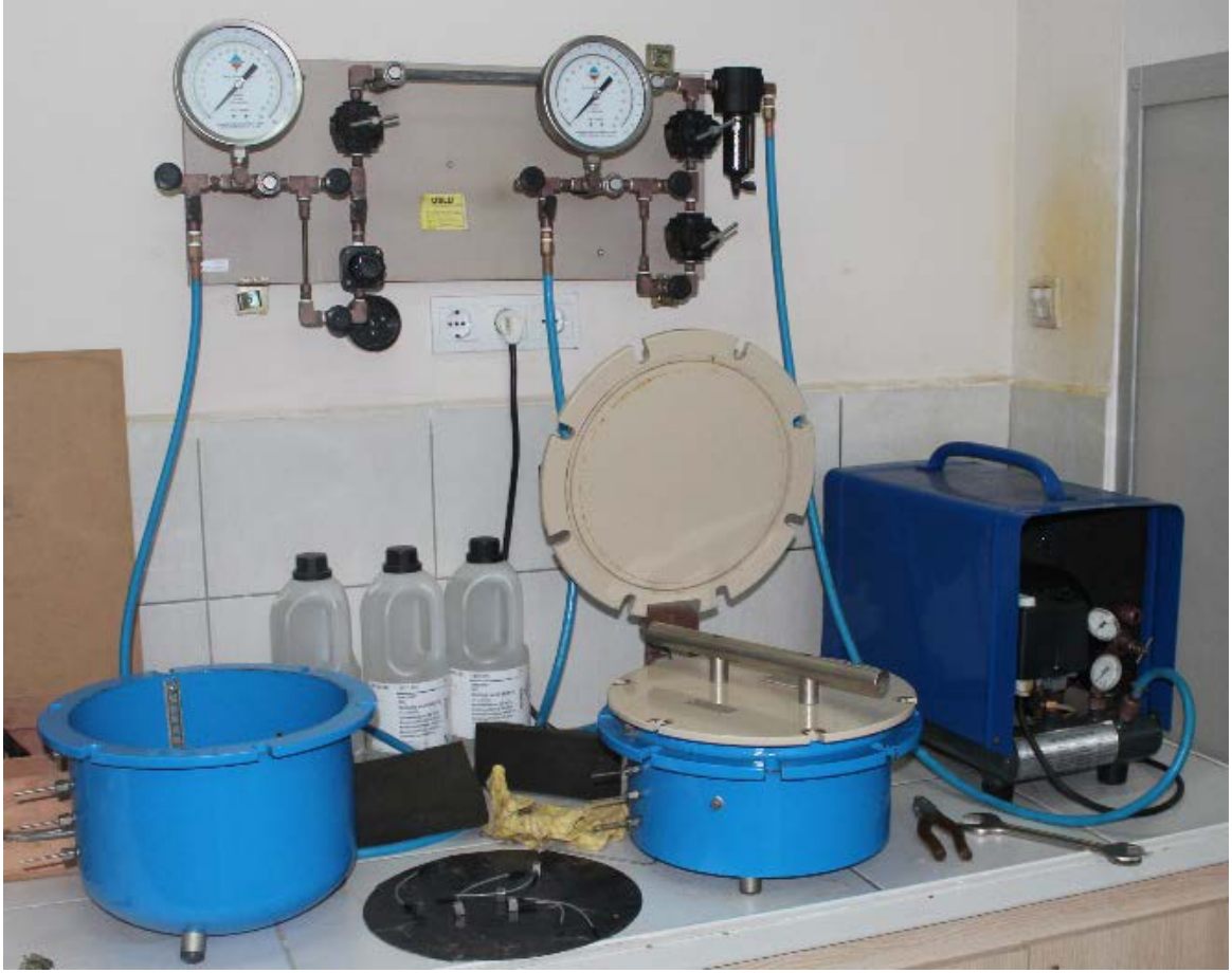
Şekil 20. Toprakların tarla kapasitesi ve solma noktası tayininde kullanılan cihaz
