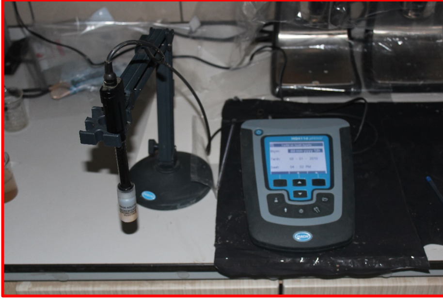
Şekil 15. pH analizinde kullanılan cihaz
