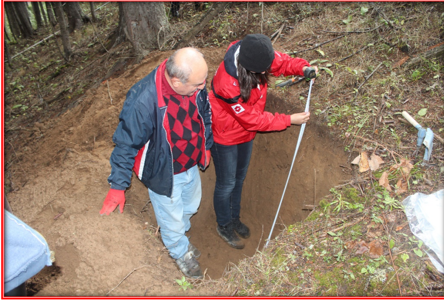
Şekil 10. Arazi çalışmalarında açılmış olan bir toprak profili
