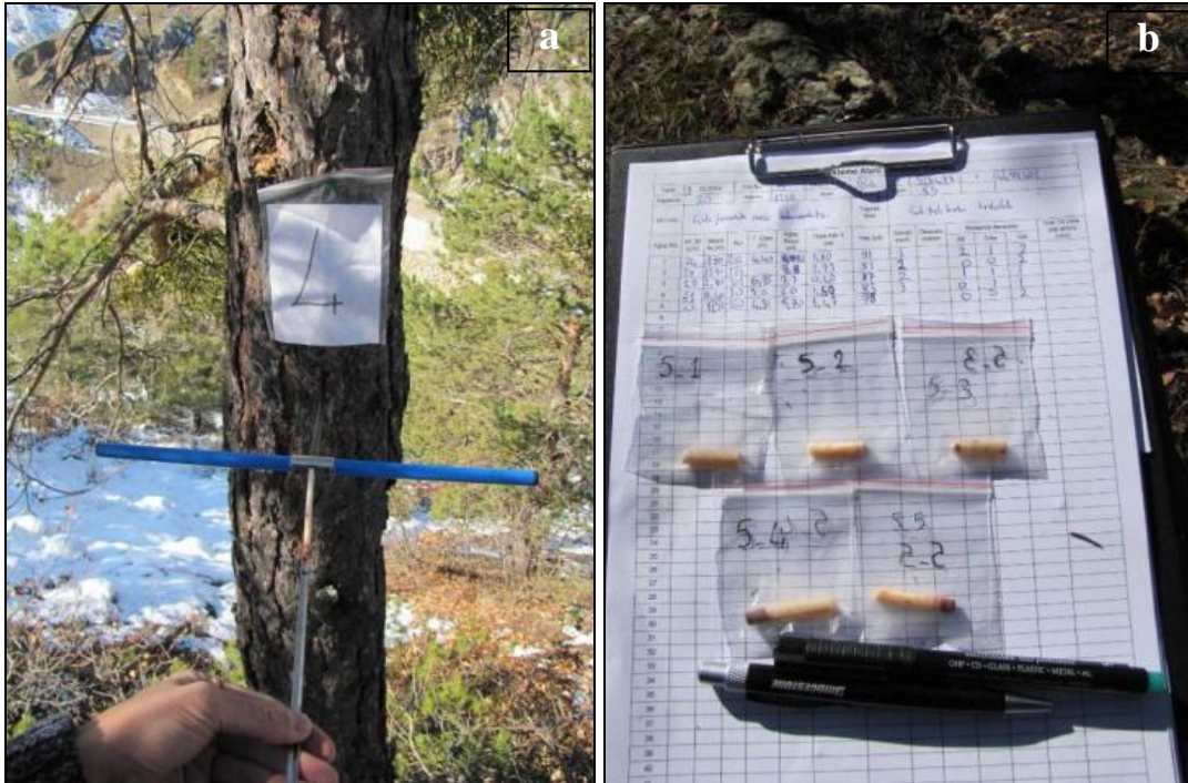
Şekil 15. Arazide örnekleme alanlarındaki ağaçlarda yaş tespiti için artım burgusu ile yaş ölçümü (a) ve son 10 yıllık artımların belirlenmesinde kullanılacak örneklerin poşetlenip numaralanması işlemleri (b)
