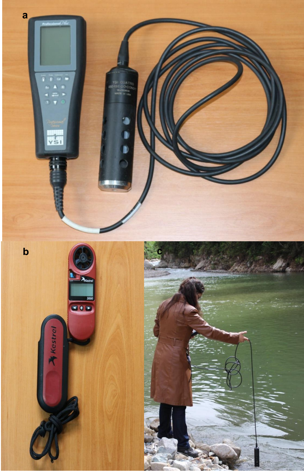
Şekil 36. YSI Professional Plus marka cihaz (a,c) ve sıcaklık-nem ölçer (b)
