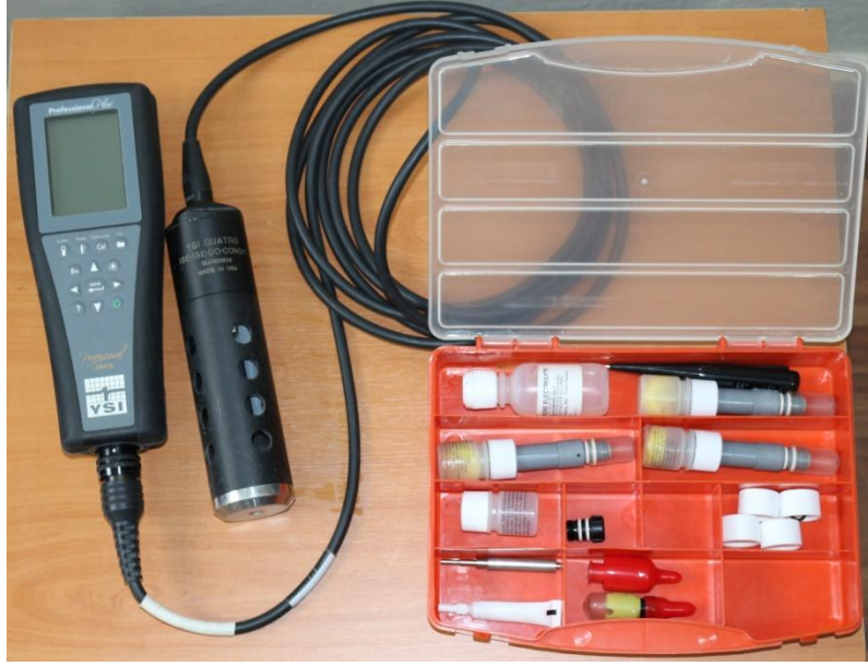
Şekil 37. YSI Professional Plus marka cihaz ve proplar
