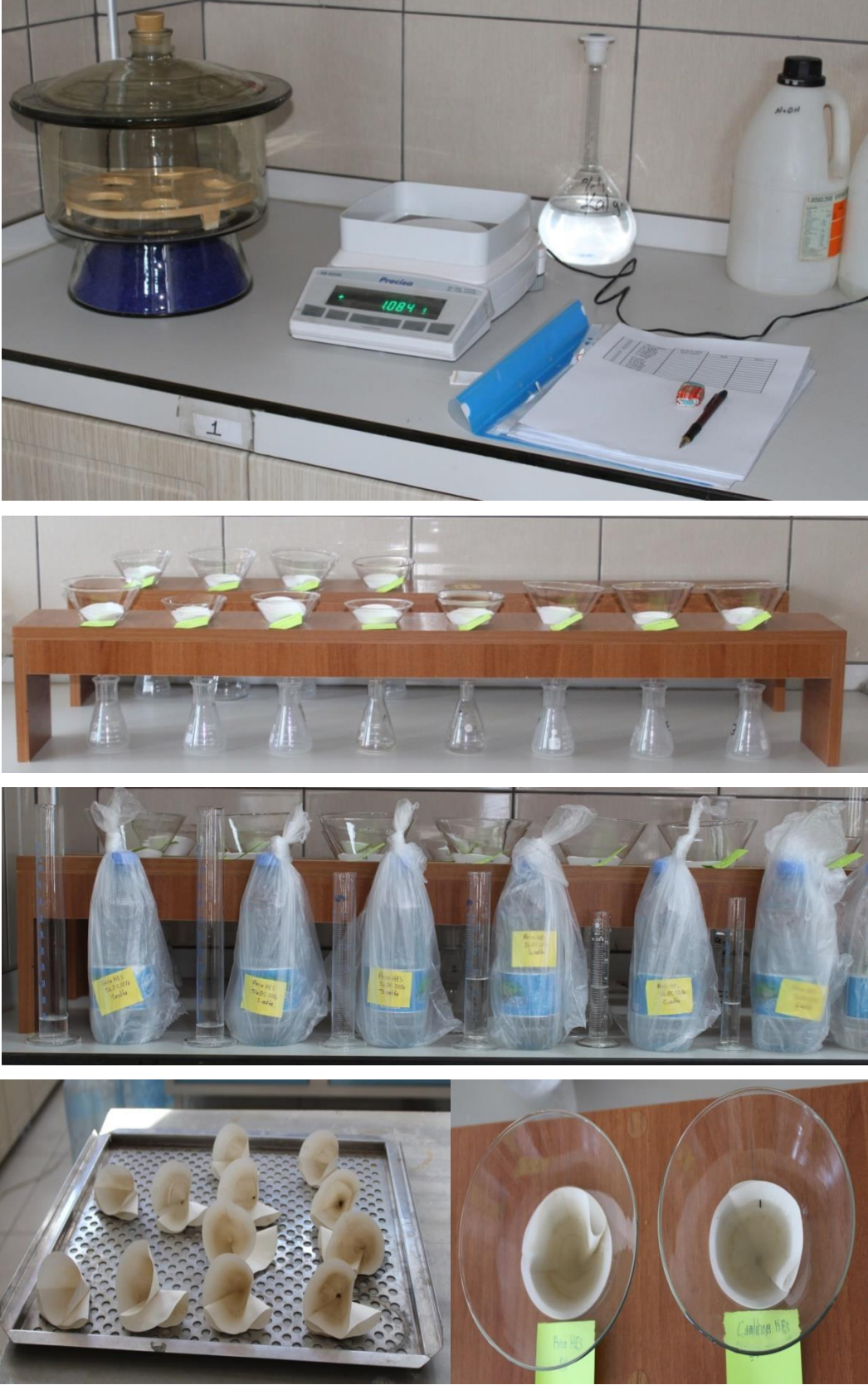
Şekil 41. Numunelerin filtre kağıdından geçirilip tartılması işlemleri
