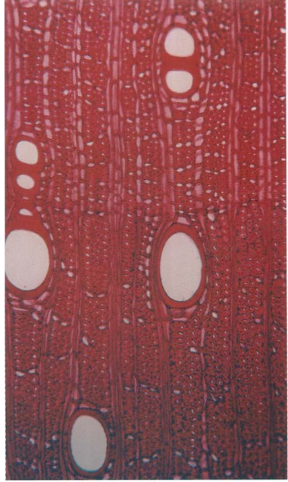
Şekil 11. Diospyros lotus L. odunundan enine kesit \times 170 .
