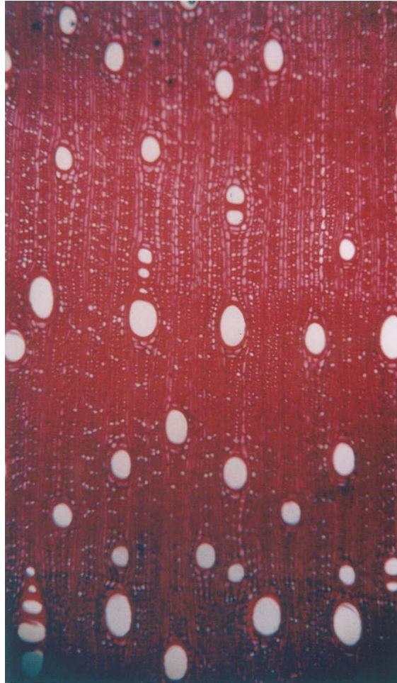
Şekil 10. Diospyros lotus L. odunundan enine kesit, yarı halkalı traheli odun \times 65 .
