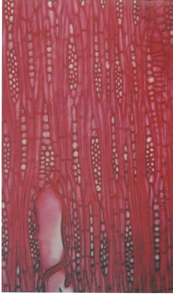
Şekil 17. Diospyros lotus L. odunundan teğetsel kesitte özışınlarında tabakalı yapı x170.
