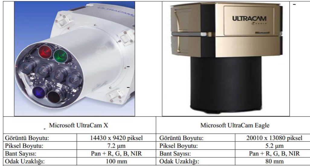
Şekil 5. Harita Genel Komutanlığı tarafından fotoğraf çekiminde kullanılan dijital hava kameraları
