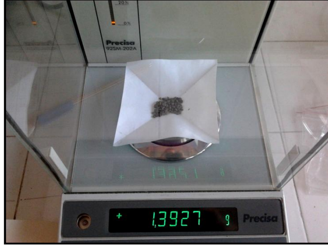
Şekil 6. Hassas elektronik terazi ile ağırlığı tartılan tohumlar
