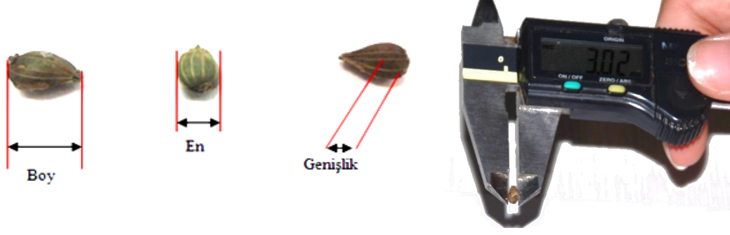
Şekil 5. Tohumların eni, boyu ve genişliğinin ölçülmesi
