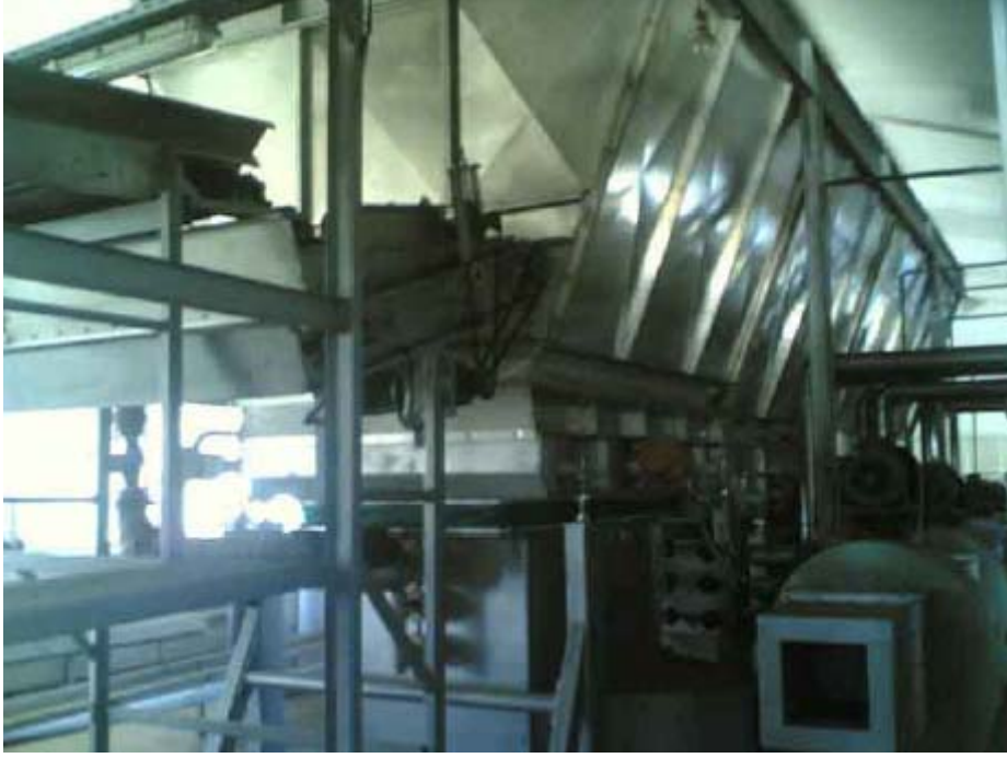
Şekil 48. Hamro tipi kurutma fırını
