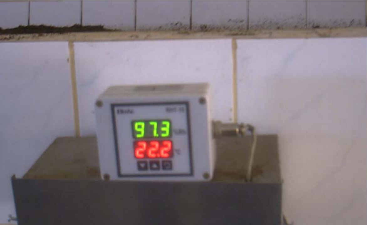
Şekil 46. Çayın fermantasyonu için ideal sıcaklık ve nemin gözlemlenmesi
