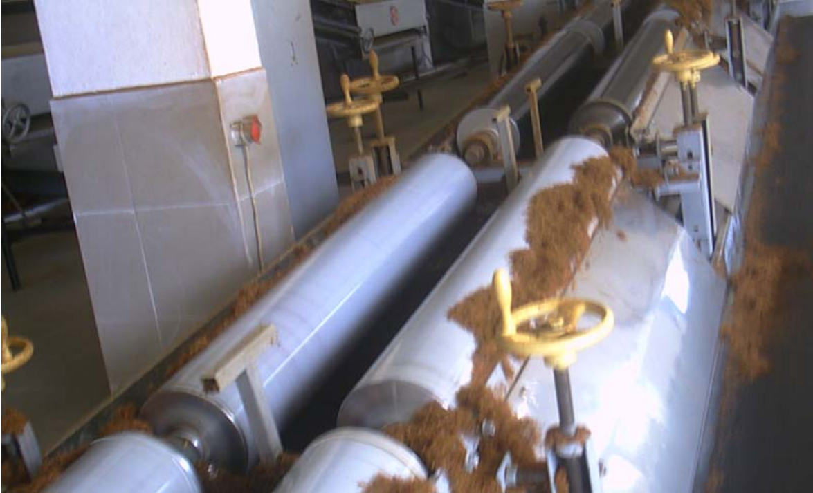
Şekil 53. Fırınlardan çıkan çay saplarının elektrostatik lif toplayıcısı ile ayıklanması
