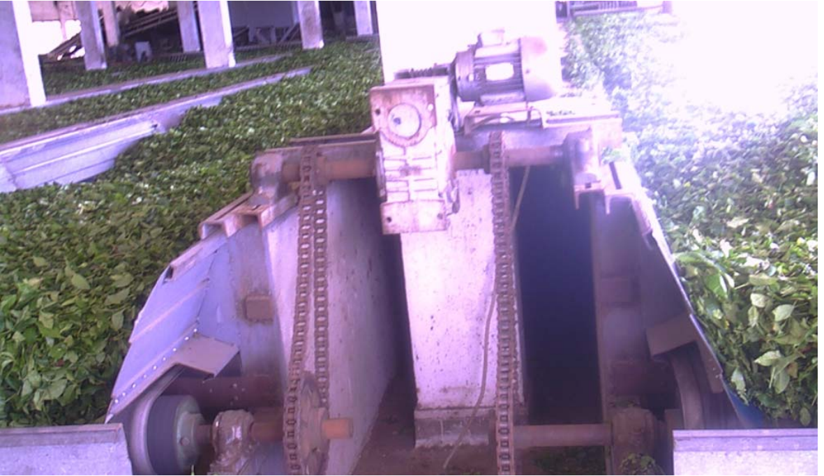
Şekil 38. Soldurma işlemi için kullanılan varyatörlü sistem
