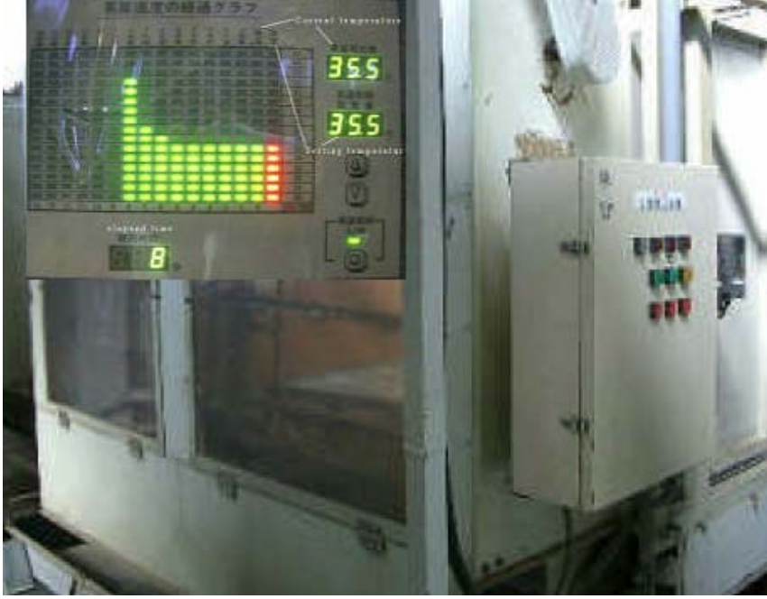
Şekil 54. Çin usulü kurutma fırını
