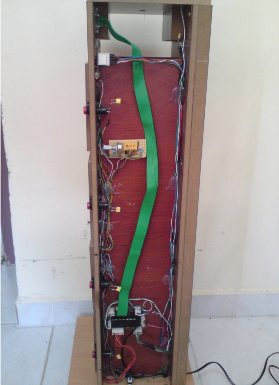
Şekil 38. Asansör modelinin anakart, motor ve butonların bağlantı devreleri
