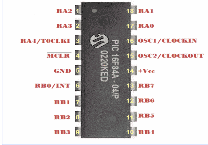
Şekil 1.22. PIC 16f84a'nın giriş ve çıkışları [9]
