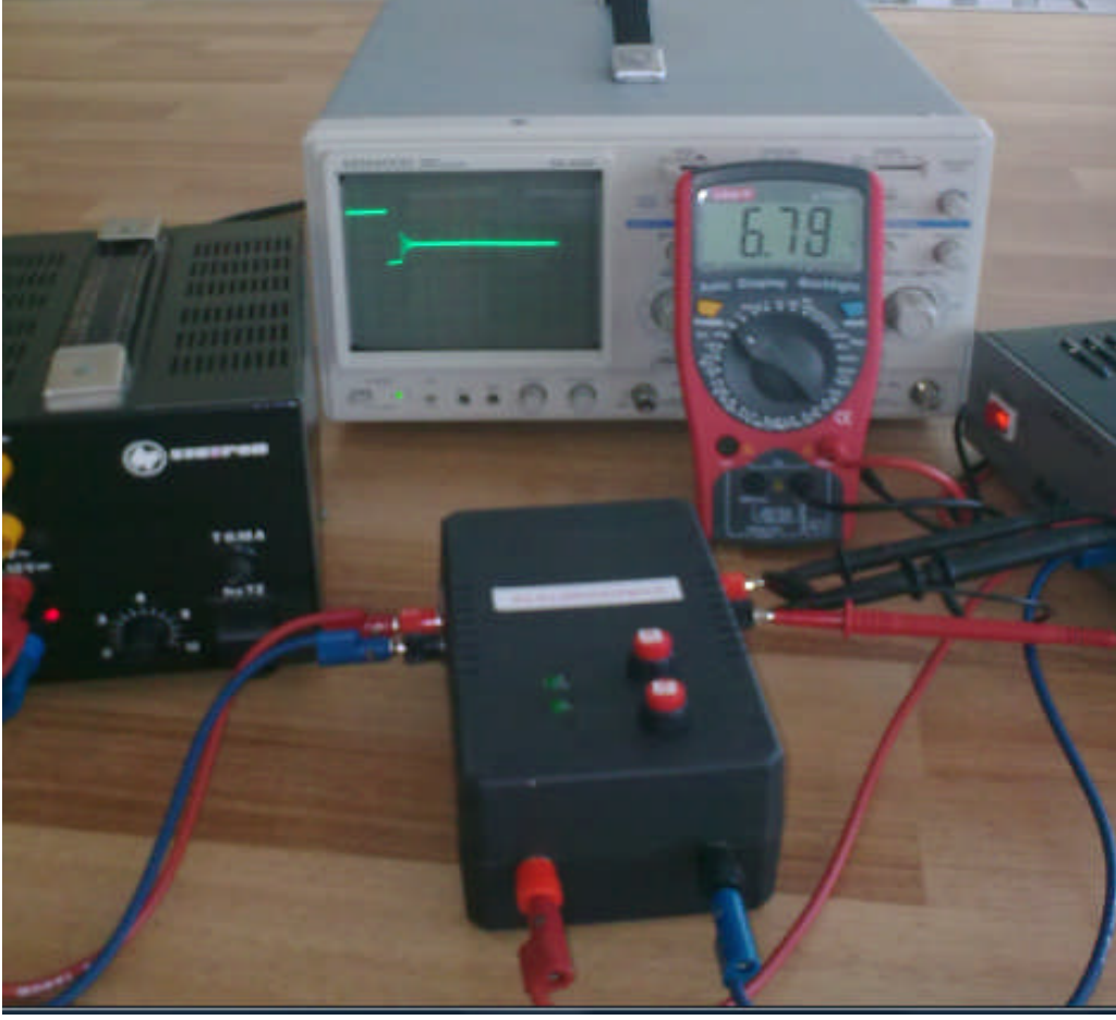
Şekil 2.30. Dönüştürücü çıkışının voltmetre ve osiloskop ile ölçümü
