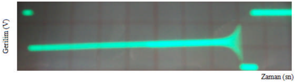
Şekil 2.29. Dönüştürücü girişi çıkışa eşit olarak çalışırken osiloskop değeri
