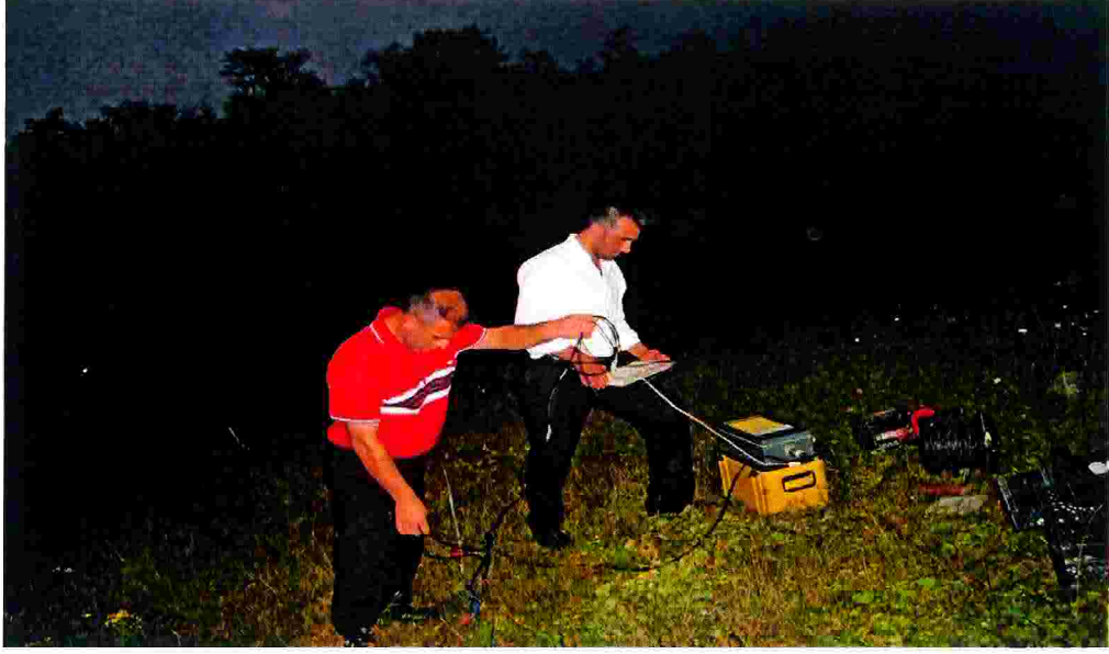
Şekil 18. Arazide kullanılan Geometrics Smart Seis sismik aleti
