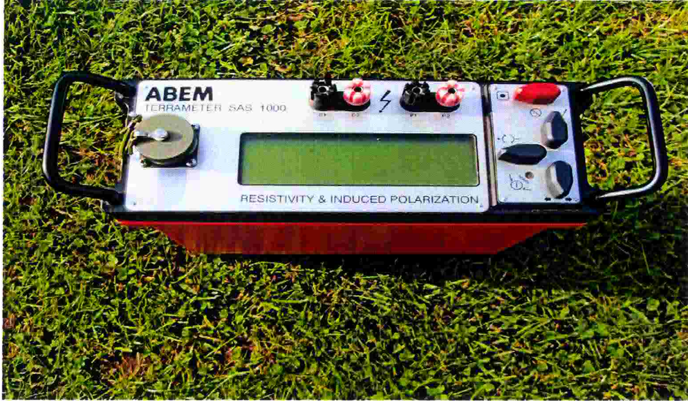
Şekil 17. Arazide kullanılan Abem Terrameter Sas 1000 elektrik özdirenç aleti
