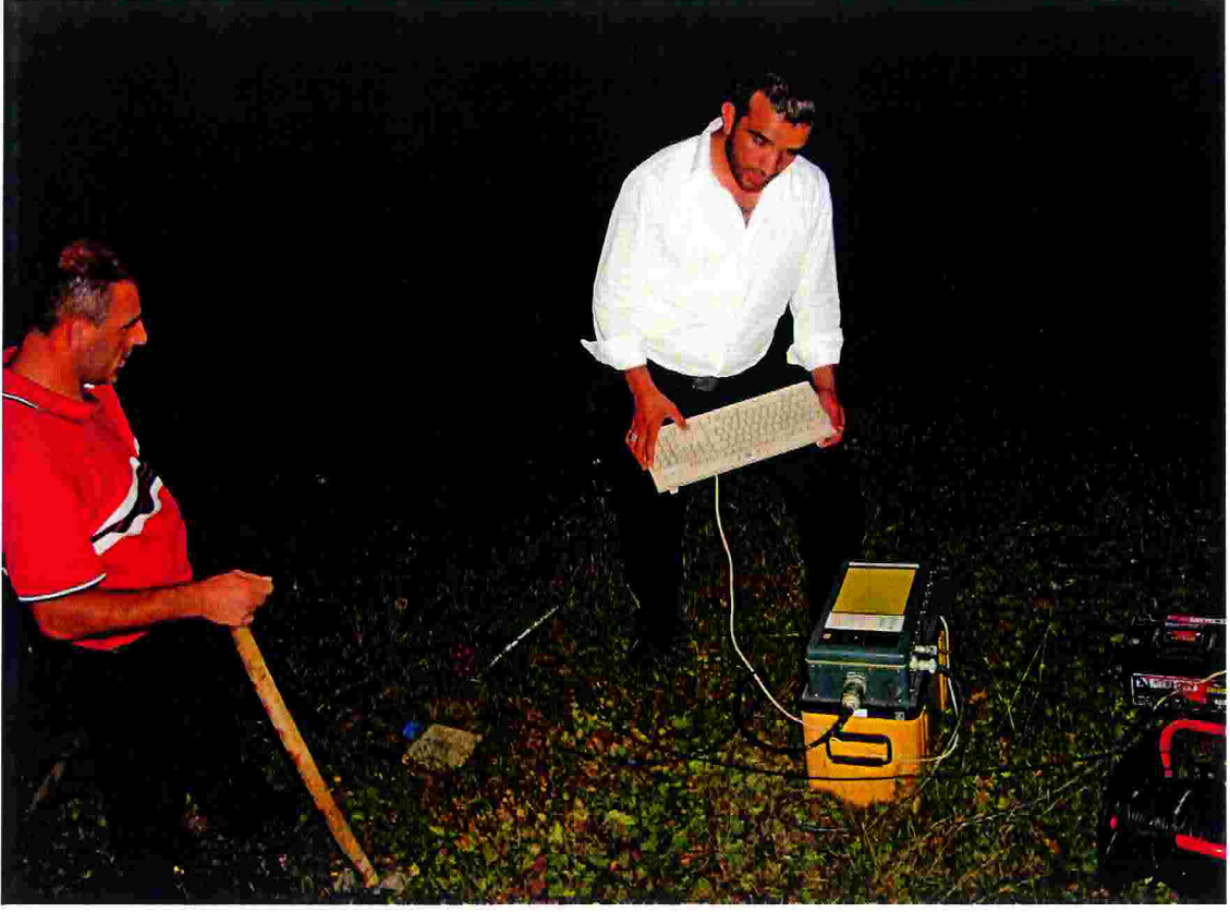
Şekil 24. Çalışma alanında sismik alet ile yapılan zemin etüdü çalışması
