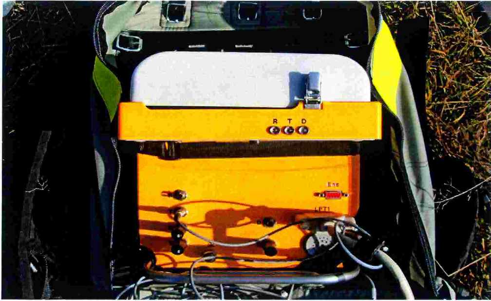
Şekil 19. Arazide kullanılan Mala Geoscience Ramac GPR yer radarı aleti
