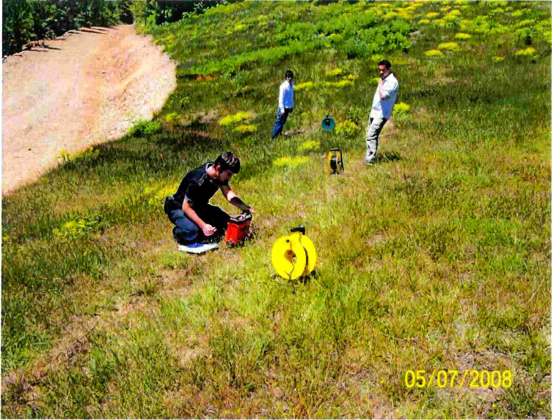
Şekil 23. Yol güzergahının 10 m üzerinden yapılan elektrik özdirenç ölçümü
