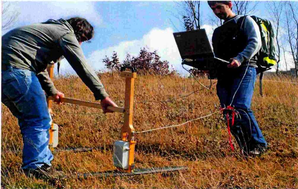
Şekil 26. Yol güzergahı boyunca 10 m yukarıdan yapılan yer radarı ölçümü
