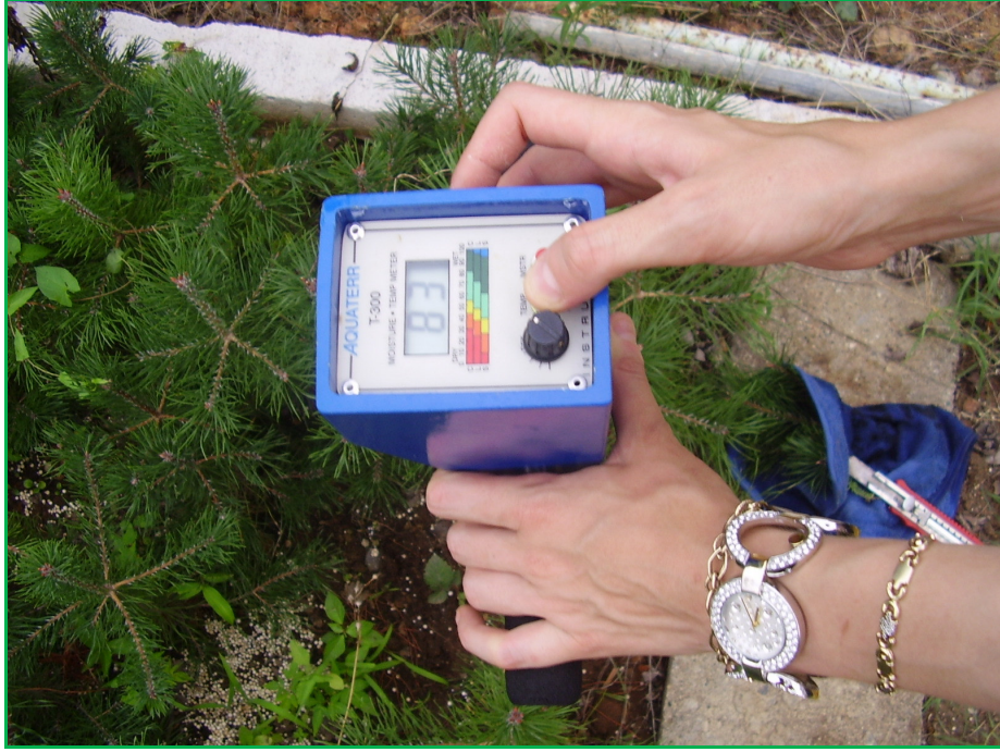
Şekil 5. Nem ve sıcaklık ölçer aletiyle (T-300 moisture-temperature meter) toprak sıcaklığı ve neminin ölçülmesi (Foto: B. BULUT).
