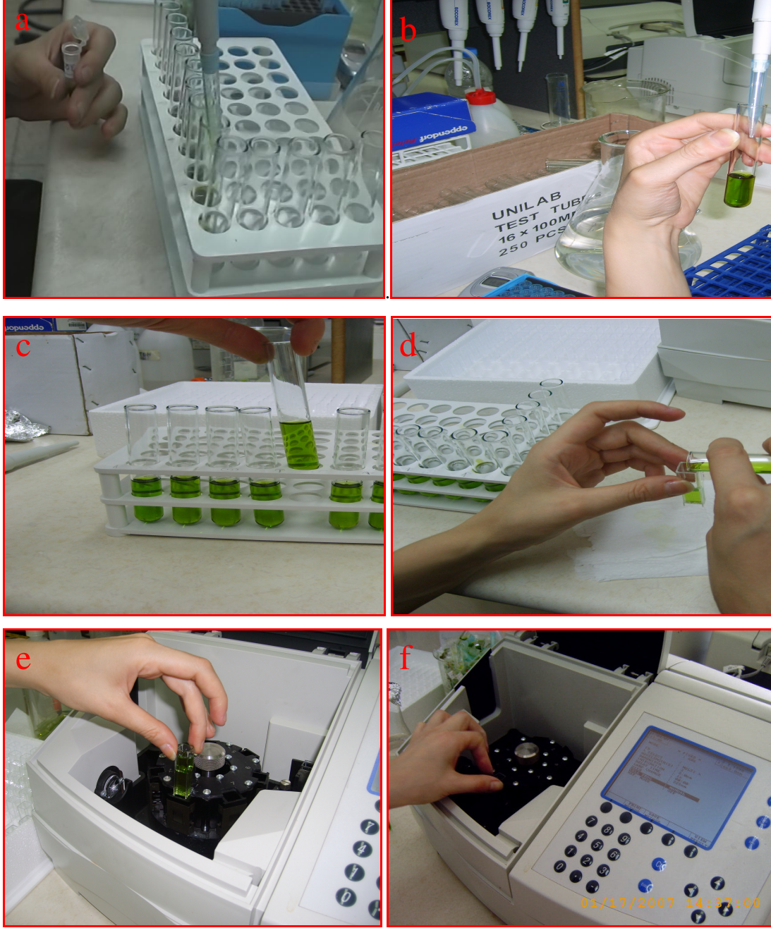
Şekil 8. Klorofil ölçümünün yapılması, a) Örneklerin eppendorf tüplerinden cam tüplere aktarılması, b) Örneklerin 5 kat seyreltilmesi, c) Seyreltilmiş beş tekrarlı numuneler, d) Örneklerin küvetlere aktarılması, e) Küvetlerin spektrofotometreye yerleştirilmesi, f) Spektrofotometreye yerleştirilen küvetlerdeki örneklerin ölçümünün yapılması (Foto: B. BULUT)
