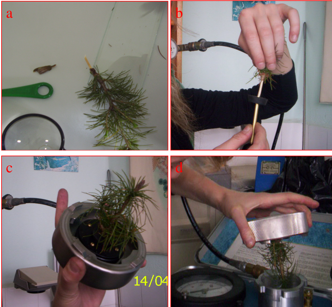
Şekil 3. Basınç odası tekniğinin uygulanması için fidanın hazırlanması, a) Fidanın ölçüm için hazırlanması b) Fidanın ölçüm için kauçuk contaya yerleştirilmesi c,d) Fidanın basınç odası cihazına yerleştirilmesi (Foto: B. BULUT)
