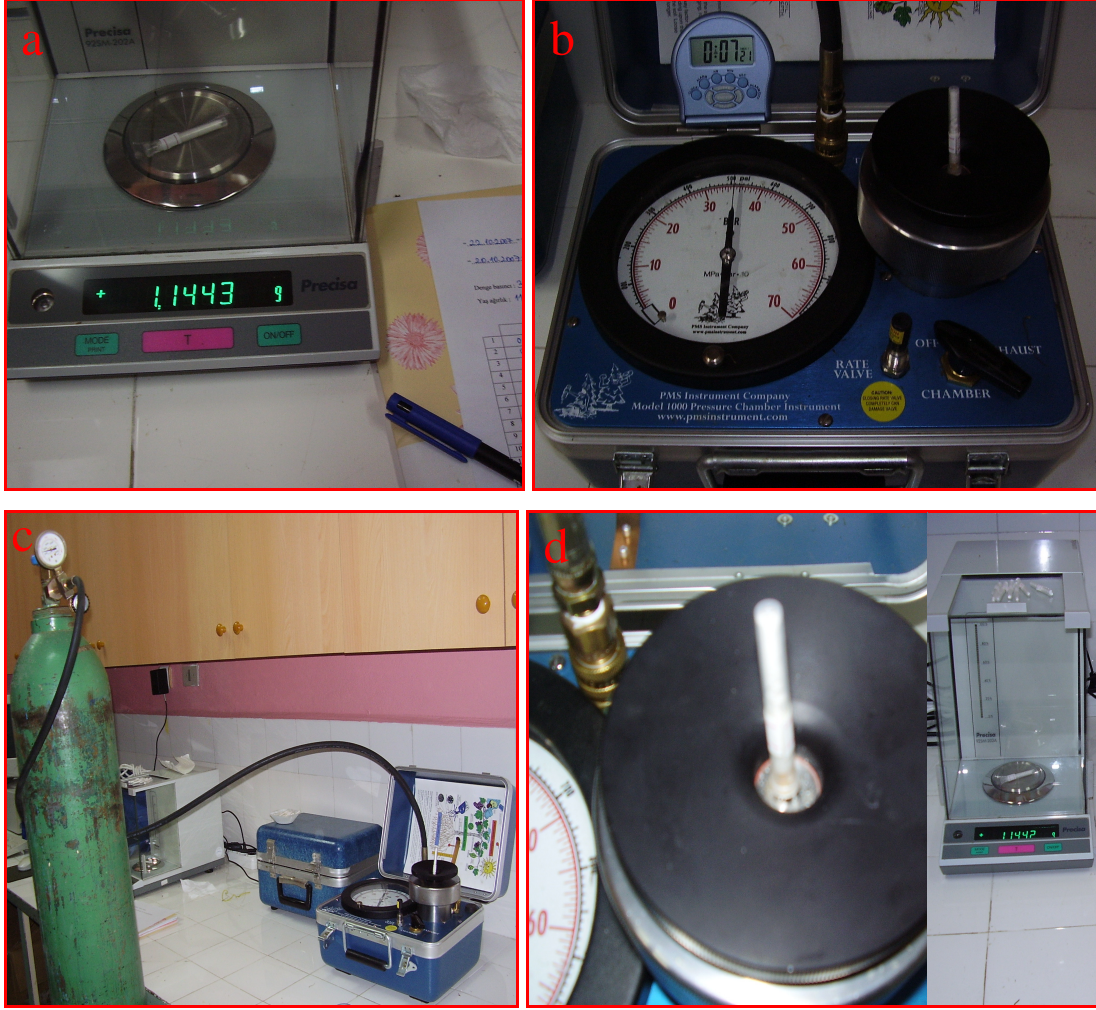
Şekil 6. Su potansiyeli bileşenlerinin tespitinde basınç odası tekniği ve uygulaması, a) filtre kağıdı yerleştirilmiş plastik tüpçüğün ölçüm öncesi kuru ağırlığının belirlenmesi, b-c) bar kademelerini artırarak ölçümün yapılması, d) filtre kağıdı yardımıyla toplanan preslenmiş suyun miktarını saptamak amacıyla plastik tüpçüğün ağırlığının belirlenmesi
