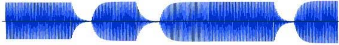
Şekil 7. Okuyucudan etikete veri iletiminde tipik işaret biçimi [4].
