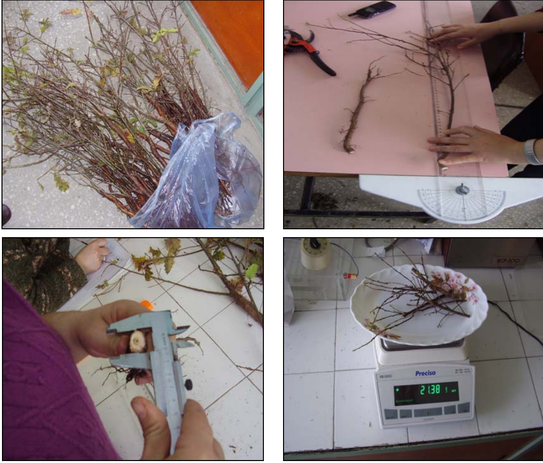
Şekil 9. Hassas elektronik terazi ile ağırlıkları tartılan, mm hassasiyetinde kök boğazı çapı, cm hassasiyetinde kök boyu ve fidan boyu ölçülen fidanlar
