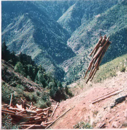
Resim 6.2: Karçkal Üretim Alanında Yükleme Yeri ve Tomrukların Aşağıya Taşınmak üzere Ana Kabloya Çekilmesi Şekli (Foto: Acar)
