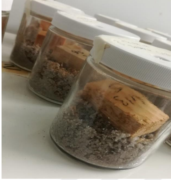
Şekil 21. Termit testi örnekleri
