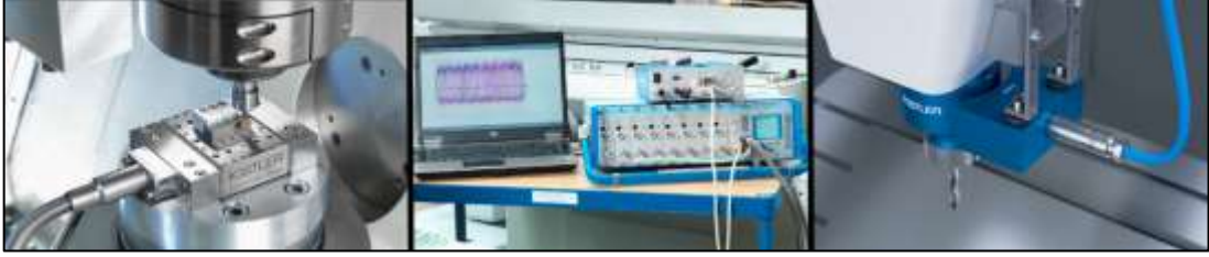
Şekil 17. Çeşitli kesme kuvveti ölçme cihazları (Kistler, 2019)
