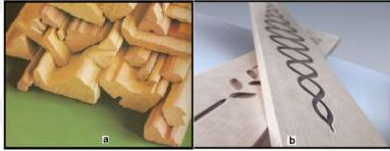
Şekil 31. Çoklu yüzey işleme makinesinde çeşitli profil ve şekilli işlenmiş parçalar
