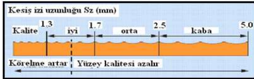
Şekil 10. Kesici izi uzunluklarında yüzey kalitesi ve körelme ilişkisi (Leitz, 2018)
