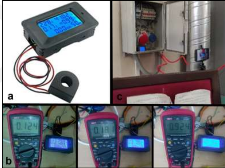
Şekil 68. Kesme gücü ölçüm aleti (a), kalibrasyonu (b) ve değerlerin kaydedilmesi (c)
