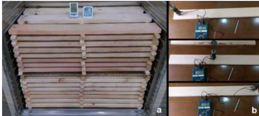
Şekil 62. İklimlendirme dolabının yerleştirilmesi (a) ve rutubet ölçümleri (b)
