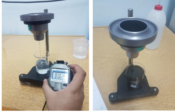
Şekil 30. Tutkalların viskozite (akma süresi) ölçümü
