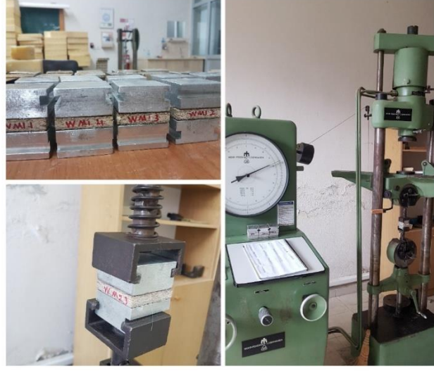
Şekil 36. Yüzeye dik çekme direnci deneyi düzeneği
