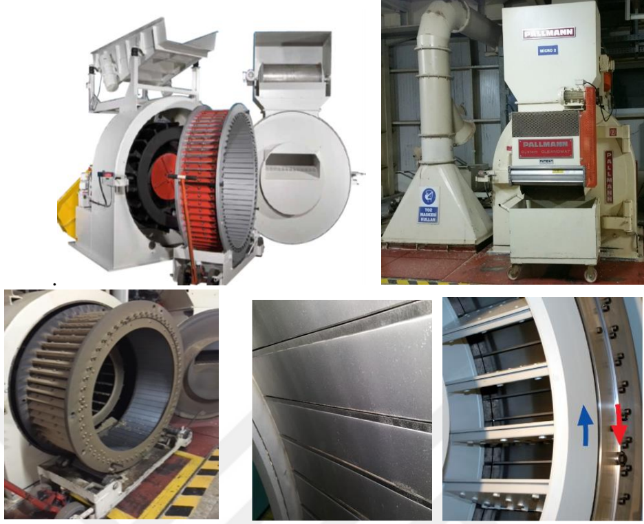
Şekil 23. Değirmen, ring ve ring bıçaklarının görünümü ve işleyişi
