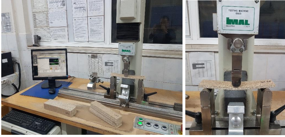
Şekil 35. Eğilme direnci ve eğilmelerde elastikiyet modülü değerlerinin belirlenmesi
