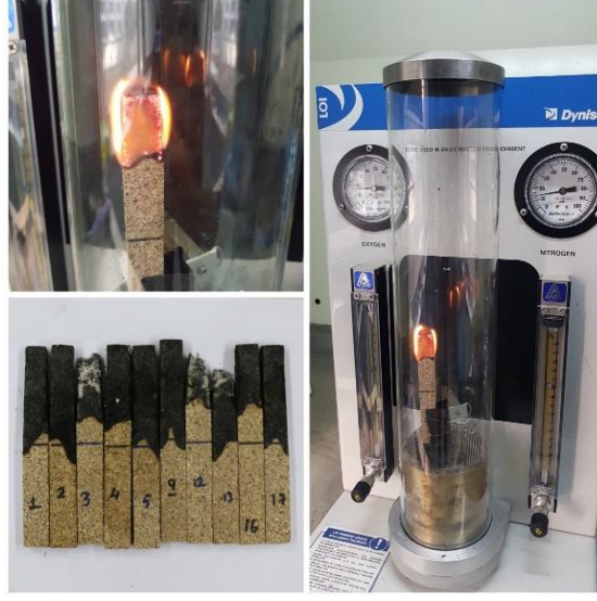
Şekil 41. Limit oksijen indeksi (LOI) test örnekleri ve düzeneği
