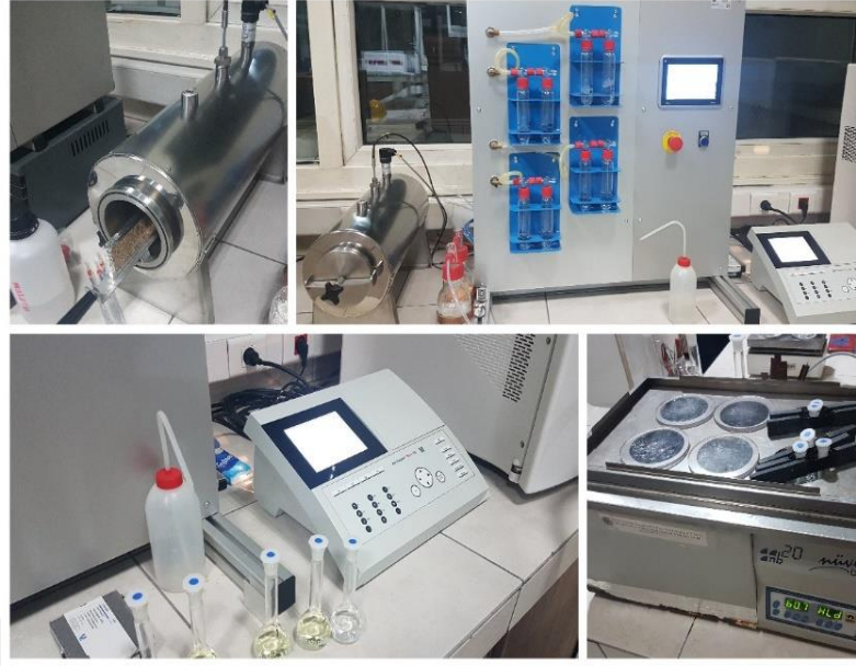
Şekil 37. Formaldehit emisyonu deney düzeneği
