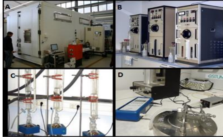
řekil 19. Formaldehit emisyonu ölçüm sistemleri (A: Oda yöntemi, B: Gaz analiz yöntemi; C: perforatör yöntemi; D: FLEC)
