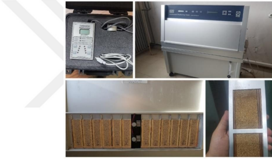
Şekil 39. Hızlandırılmış yaşlandırma (QUV test) düzeneği
