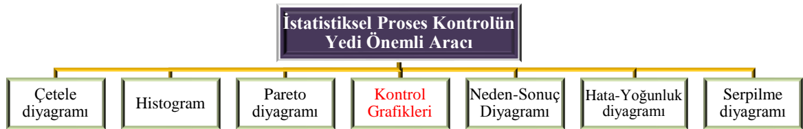
Şekil 4. İstatistiksel proses kontrolün yedi önemli aracı (Montgomery ve Runger, 2010)
