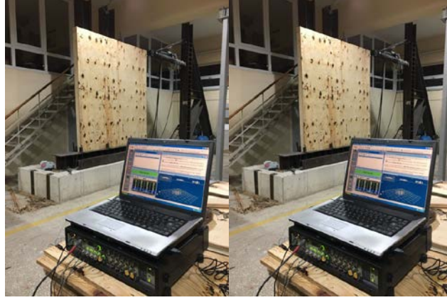
Şekil 42. İvme ölçerlerin duvar üzerine uygulanması
