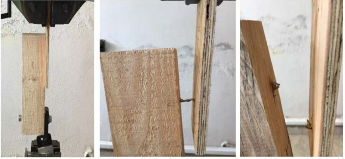
Şekil 32. Yanal vida direnci test düzeneği ve test sonunda meydana gelen değişim
