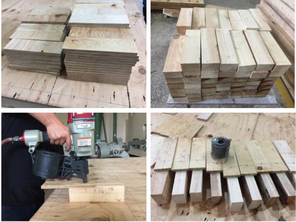
Şekil 31. Yanal vida direnci deneyi için örneklerin hazırlanması
