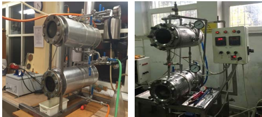
Şekil 6. Boş hücre yöntemi için kullanılan emprenye sistemi
