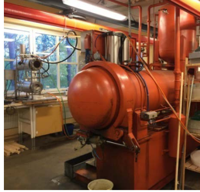
Şekil 5. Dolu hücre yöntemi için kullanılan emprenye sistemi
