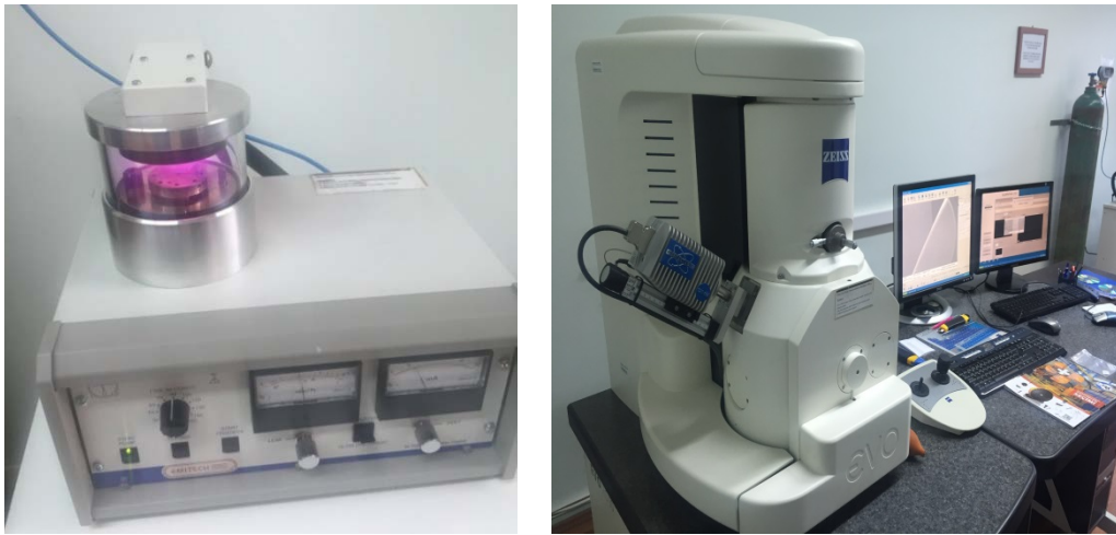
Şekil 18. SEM'de görüntülerin alınması ve kaplama işlemi
