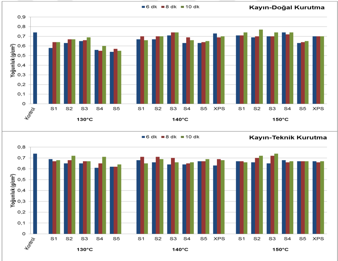
Şekil 42. Doğal ve teknik kurutma uygulanmış kayın kaplamalardan üretilen kontrplak levhalarının yoğunluk test sonuçları
