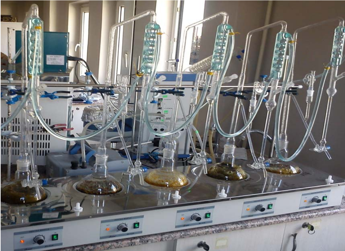
Şekil 2.8. Çalışmada kullanılan Clevenger düzeneği
