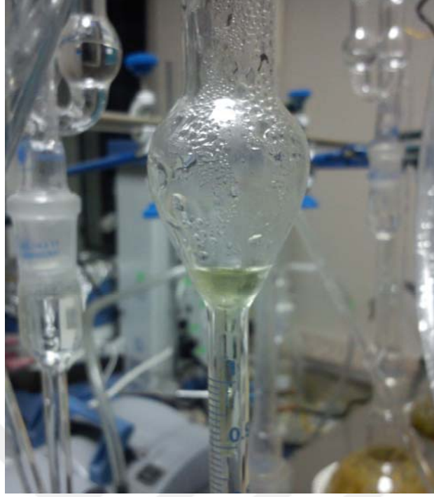
Şekil 2.9. Uçucu yağların toplanması
