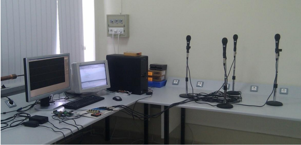
Şekil 25. TDOA tabanlı akustik kaynak konumlandırma için kurulan sistem
