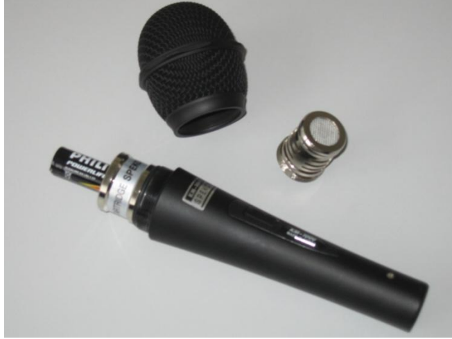
Şekil 17. Konumlandırma sisteminde kullanılan elektret mikrofon
