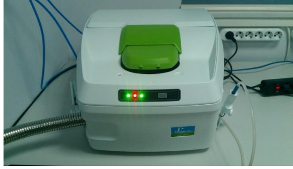
Şekil 35. DSC analizinin yapılması
