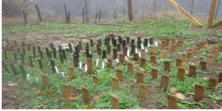
Şekil 19. Toprakla temas testinin görünüşü
