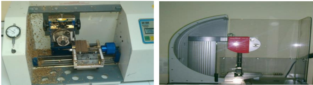
Şekil 32. Levhalara çentik açılması ve darbe direncinin belirlenmesi
