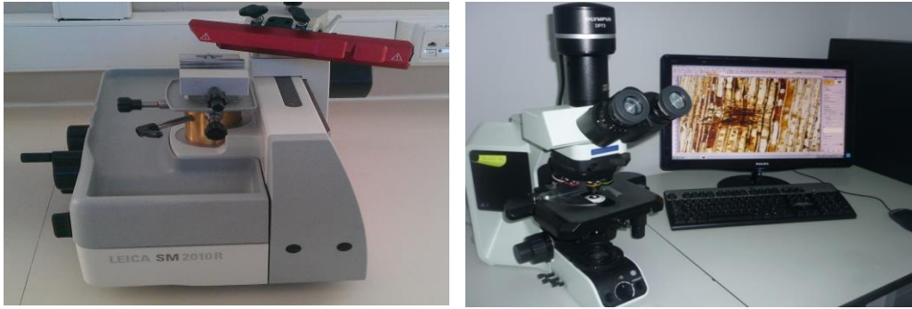
Şekil 7. Örneklerden kesit alınması ve tür teşhisi
