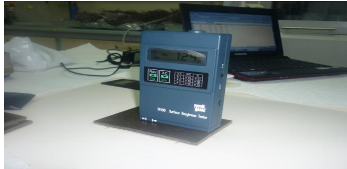
Şekil 23. Levhaların yüzey pürüzlülük ölçümleri
