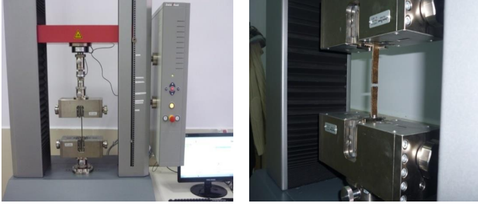
Şekil 31. Levhaların çekme özelliklerinin belirlenmesi
