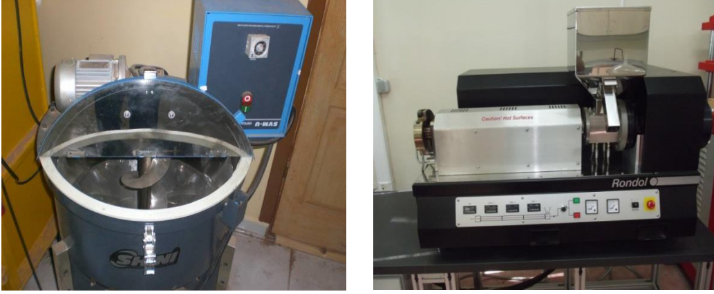
Şekil 14. Karıştırıcı ve ekstrüder makine sistemi
