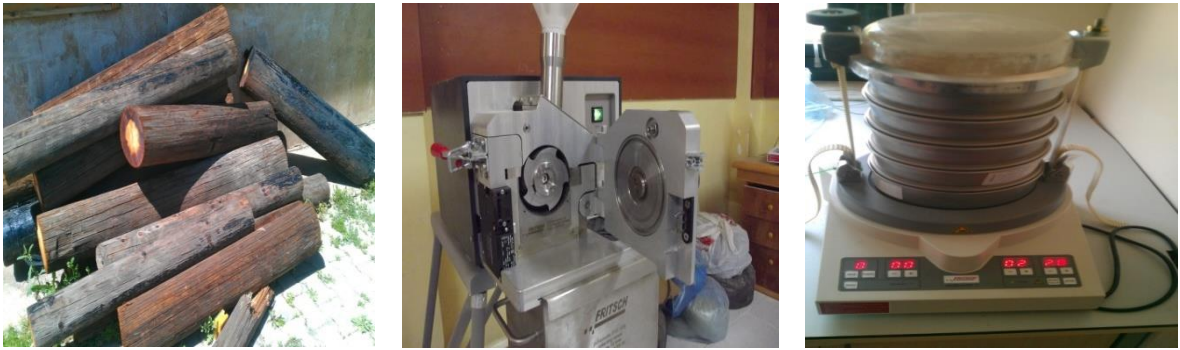
Şekil 13. Willey değirmeninde örneklerin öğütülmesi ve eleme işlemi
