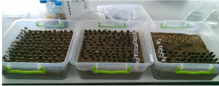
Şekil 28. ENV 807 standardına göre yumuşak çürüklük testinin yapılması
