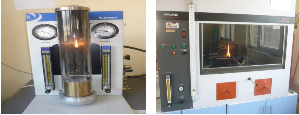
Şekil 36. Levhaların Limit Oksijen İndeksi (LOİ) ve Alevin Yayılma Hızı Testleri
