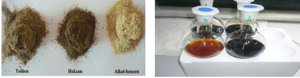
Şekil 9. Kreozot içeriğinin belirlenmesi
