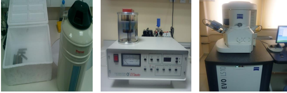
Şekil 37. Levhalara sıvı azot muamelesi sonrası altın kaplama uygulaması ve SEM analizi
