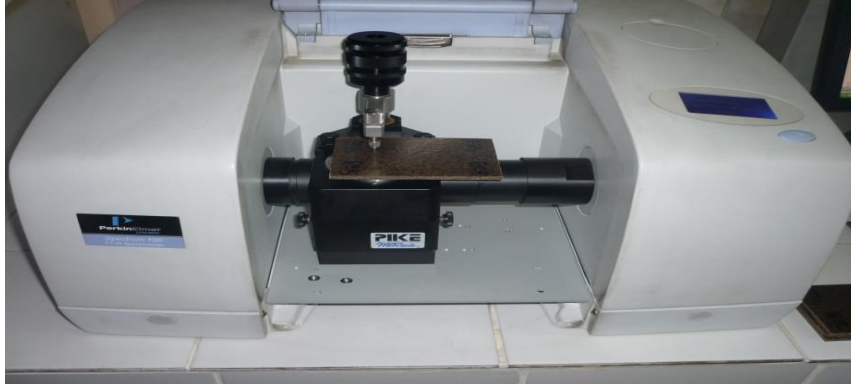
Şekil 26. Dış ortam testleri sonrası FTIR-ATR yardımı ile yüzeylerde meydana gelen kimyasal değişimin belirlenmesi
