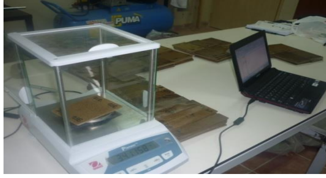
Şekil 22. Levhaların ağırlık ölçümleri
