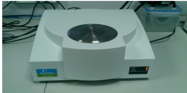
Şekil 34. TGA analizinin yapılması
