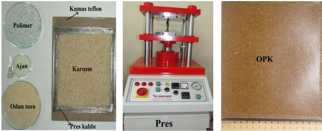
Şekil 15. Üretim reçetesine göre karışımların hazırlanarak preslenmesi
