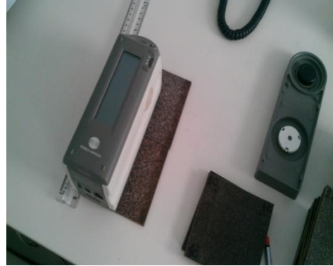
Şekil 24. CIELab renk sisteminin gösterimi ve levhaların renk ölçümleri
