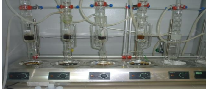
Şekil 11. Kreozotun Hekzan ile sokslet ekstraksiyonu
