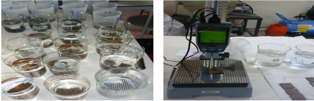
Şekil 29. Levhaların periyodik su alma testi ve kalınlık ölçümleri
