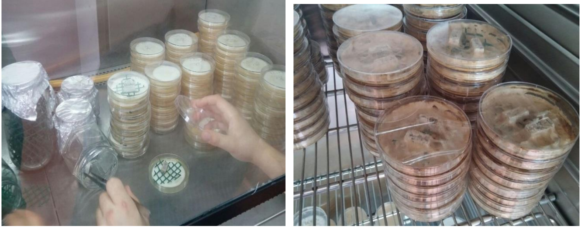
Şekil 37. Mantar çürüklük testi örnekleri
