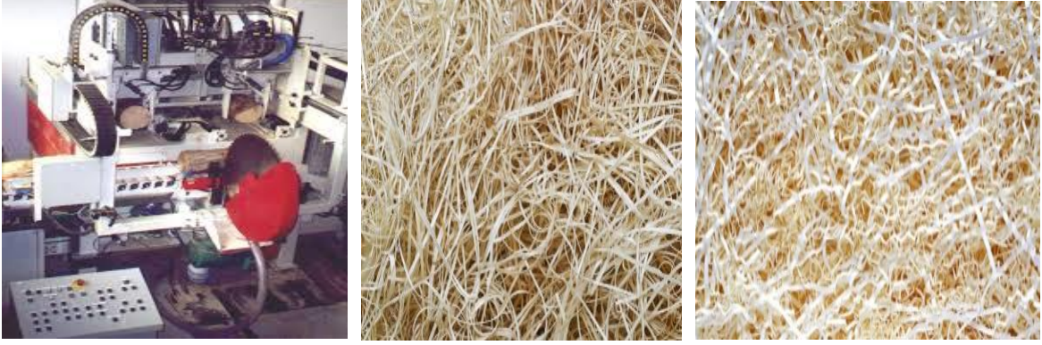
Şekil 10. Odun yünü üretim makinesi ve odun yünü örnekleri [38].
