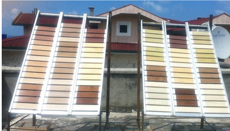
Şekil 9. Sürmene sahil kesimi doğal dış ortam test düzeneği
