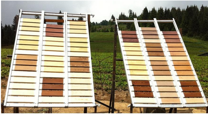
Şekil 11. Hıdırnebi yaylası doğal dış ortam test düzeneği
