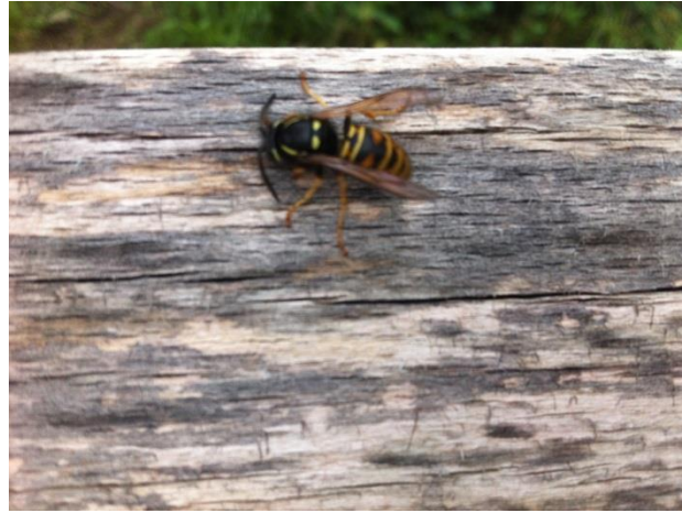
Şekil 49. Sürmene sahil kesiminde dış ortam koşullarına maruz bırakılan doğu kayını odununa biyolojik canlıların verdiği zarar
