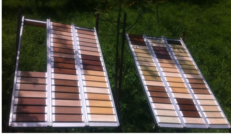
Şekil 10. Uzungöl yaylası doğal dış ortam test düzeneği
