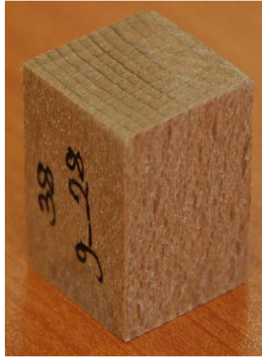
Şekil 18. Daralma ve genişleme deney örneği
