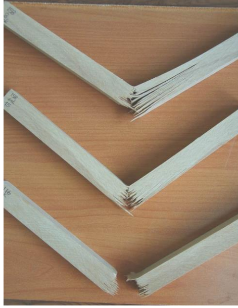
Şekil 21. Dinamik eğilme direnci sonrası örneklerde meydana gelen farklı kırılma şekilleri
