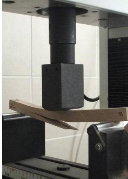
Şekil 20. Statik eğilme direnci ve eğilmede elastikiyet modülü deneylei
