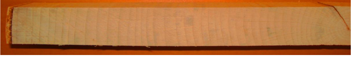
Şekil 15. Yıllık halka genişliği ölçümü için hazırlanmış bir odun örneği
