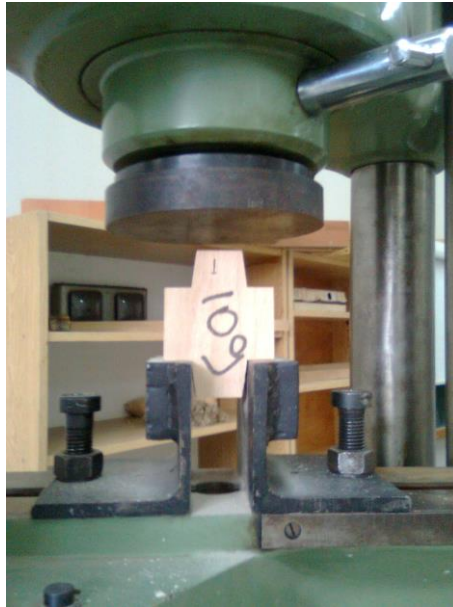
Şekil 22. Liflere paralel yönde makaslama direnci deneyi
