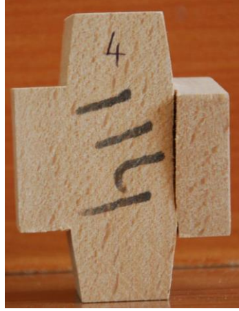
Şekil 23. Liflere paralel yönde makaslama direnci deneyi sonrası kırılma şekli
