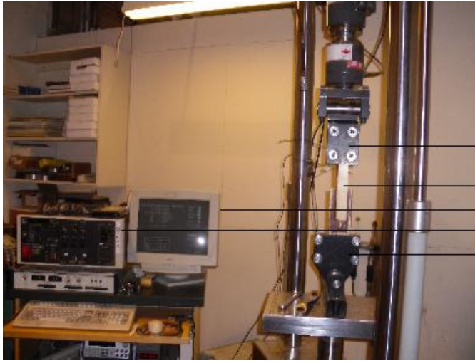
Şekil 27. Yanal vida dayanımı deney düzeneği
