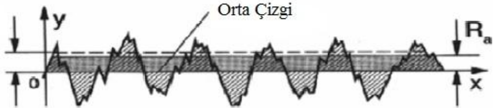
Şekil 20. Ortalama pürüzlülüğün ( R_a ) gösterimi
