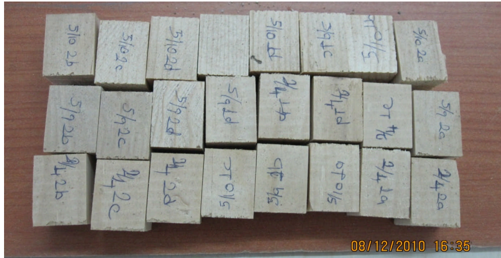
Şekil 21. Yoğunluk deney örnekleri [Foto, Ulusoy]
