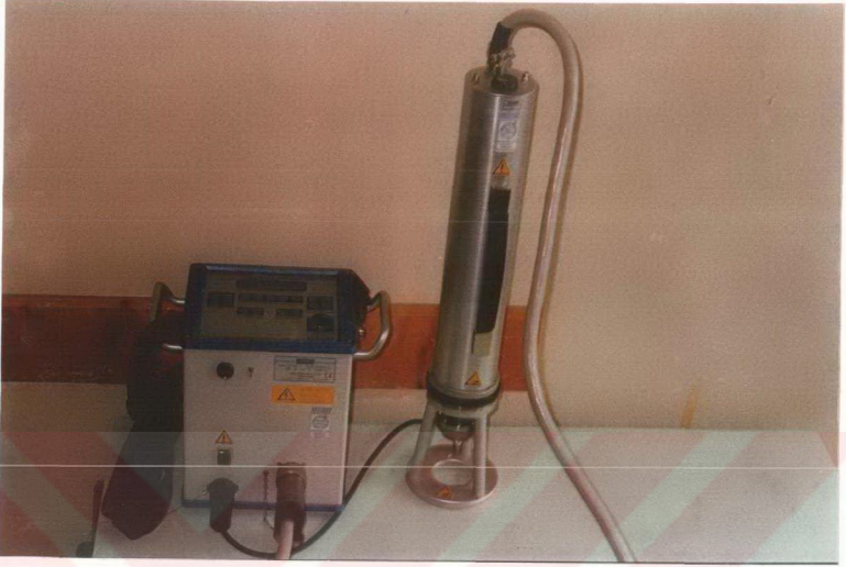
Şekil 5. Yapışma direnci test aleti
