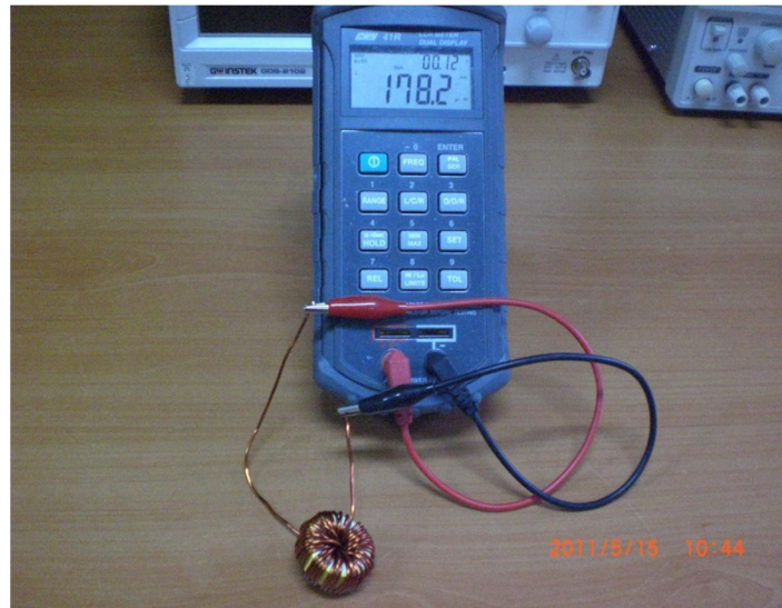
Şekil 2.34. Çevirici için endüktans sarımı
