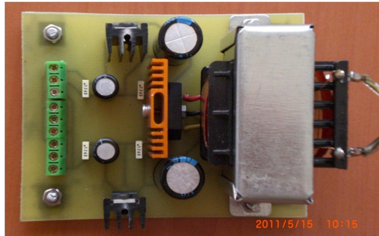
Şekil 2.26. \pm 15V DA gerilim regülatörü
