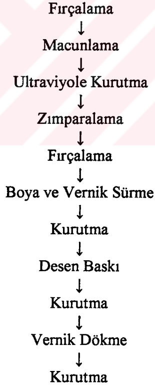
Şekil 2. Yongalevha üzerine desen baskılı işlemlerde iş akışı.
