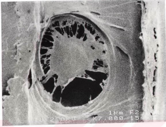
Şekil 22. Mekanik Bir Etki Sonucu Hasar Görmüş Bir Dirî Odun Kenarlı Geçit Çifti
