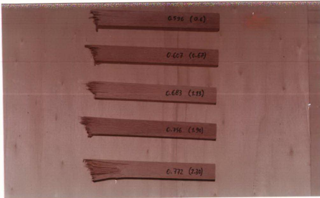
Şekil 46. Dinamik eğilme direnci örnekleri kırılma şekilleri.
