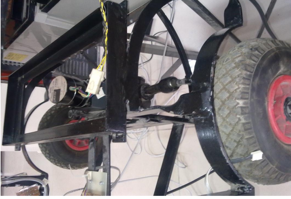
Şekil 2.4. Redüktörlü adım motoru ve araç dönüş sistemi
