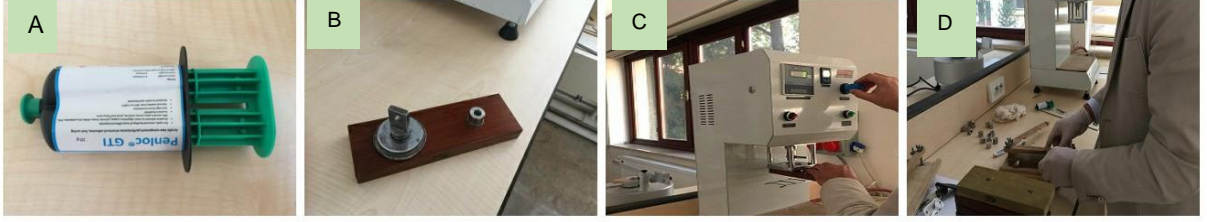
Şekil 20. A. Pnömatik adezyon ölçümleri için kullanılan yapıştırıcı B. Aparatların örnek yüzeyine yapıştırılması C. Deney cihazı Pnömatik adezyon cihazı D. Test sonrası
