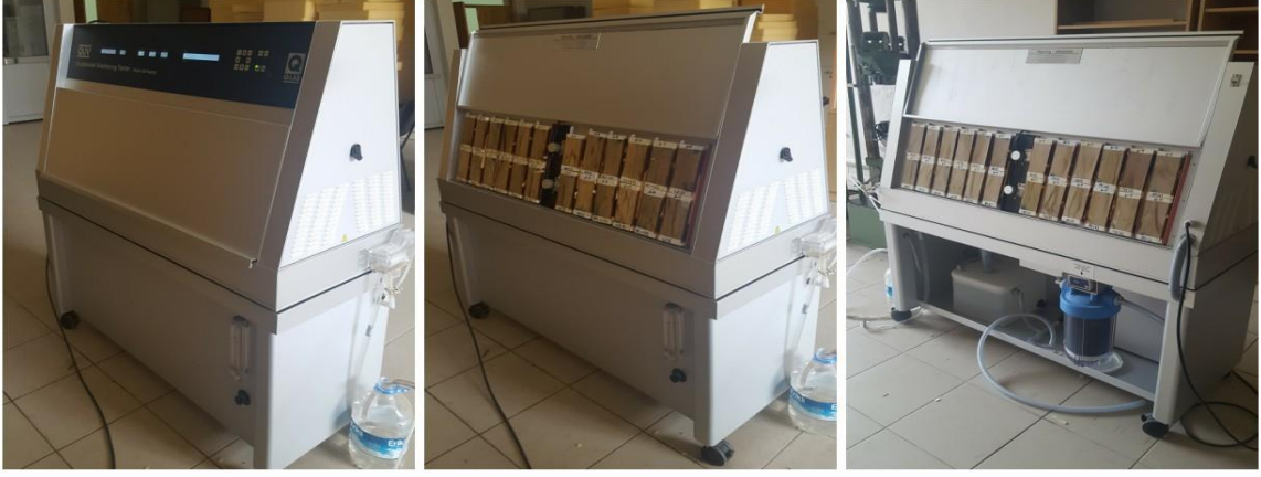
Şekil 23. Yapay dış ortam test cihazı (QUV Test)
