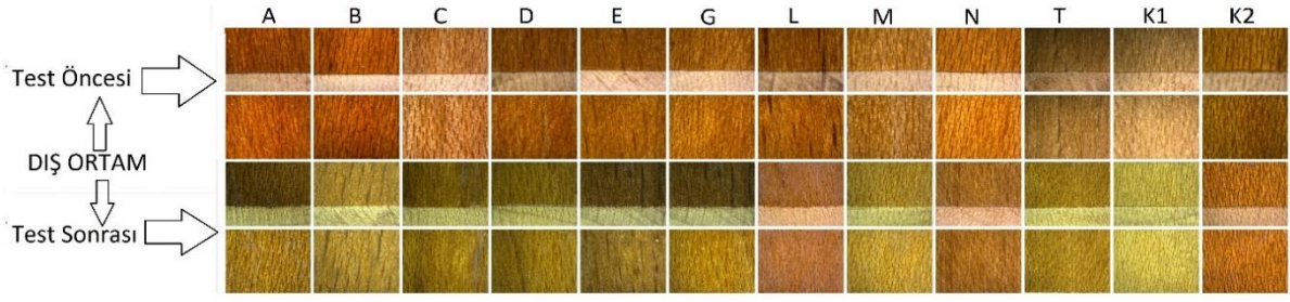
Şekil 99. Yapay dış ortam öncesi ve sonrası Y grubu kayın yüzeyinde test ve kontrol verniklerinin mikroskopik görüntüsü.
