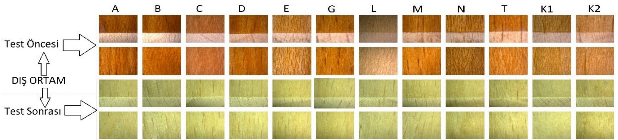
Şekil 92. Doğal dış ortam koşullarına maruz kalan Z grubu kayın ve sarıçam yüzeylerine uygulanan test ve kontrol verniklerinin katman kalınlıklarındaki değişim oranı
