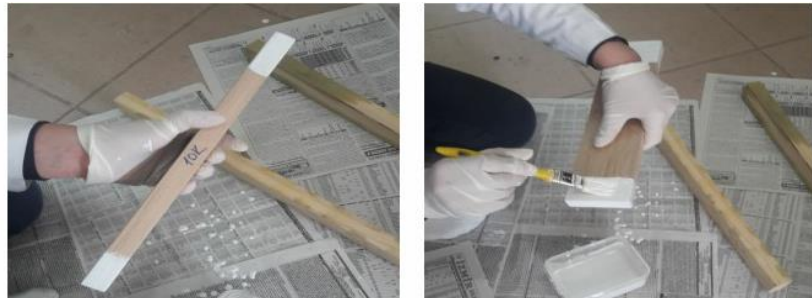
Şekil 16. Örneklerin doğal dış ortam testi için hazırlanması
