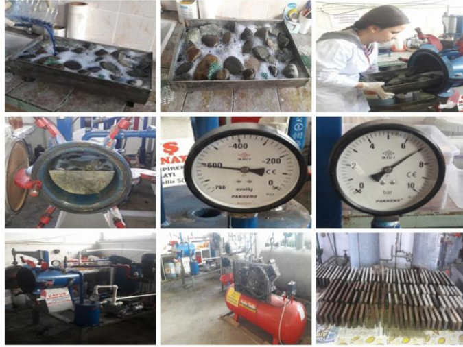
Şekil 14. Emprenye tesisinde empenye işlemi uygulaması
