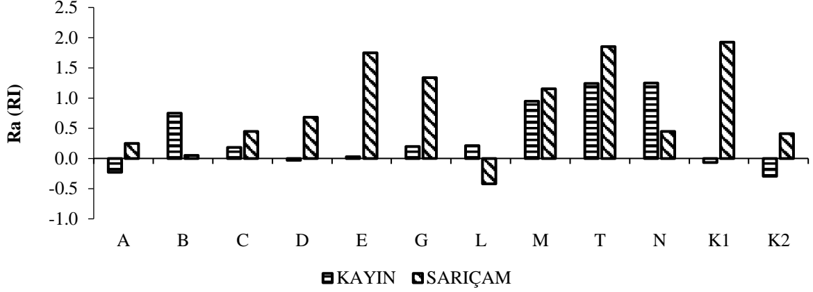
Şekil 82. Yapay dış ortam testine maruz kalan Y grubu kayın ve sarıçam yüzeylerinde test ve kontrol verniklerinin yüzey pürüzlülük ( R_a ) indeksi değeri (RI)
