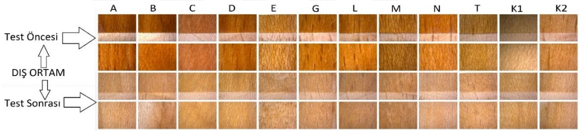
Şekil 102. Yapay dış ortam öncesi ve sonrası Z grubu kayın yüzeyinde test ve kontrol verniklerinin mikroskopik görüntüsü.
