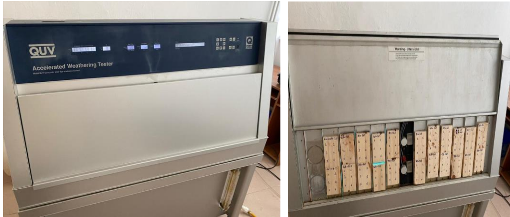
Şekil 11. Cihazda örneklere uygulanan yapay dış ortam testi
