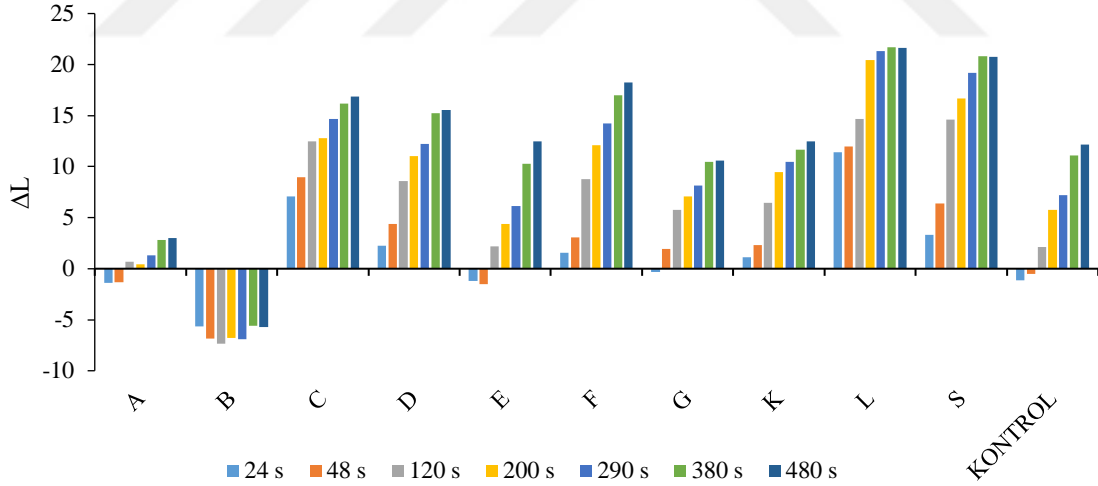
Şekil 22. Yapay dış ortam testine tabi tutulan sarıçam örneklerinde oluşan ışık stabilite ( \Delta L ) değerleri
