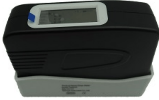
Şekil 3. Yüzey parlaklık ölçüm cihazı (Surface gloss meter) [12].
