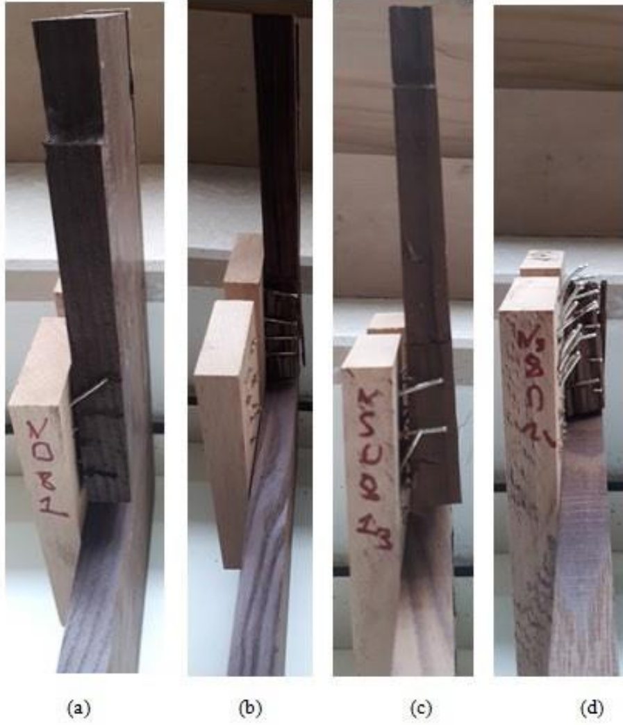
Şekil 30. Isıl işlemlili dişbudak örneklerinden oluşturulmuş çift sıra 8 zımbalı birleştirme yerlerine ait ayrılma biçimlerinin önden görüşleri a) 1 nolu, b) 2 nolu, c) 3 nolu, d) 4 nolu birleştirme yerleri
