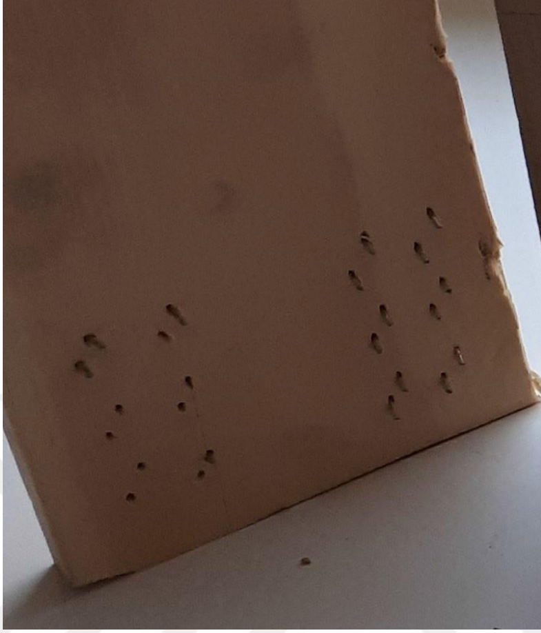
Şekil 18. Zimba malzemesinin devirli yük altında kopması
