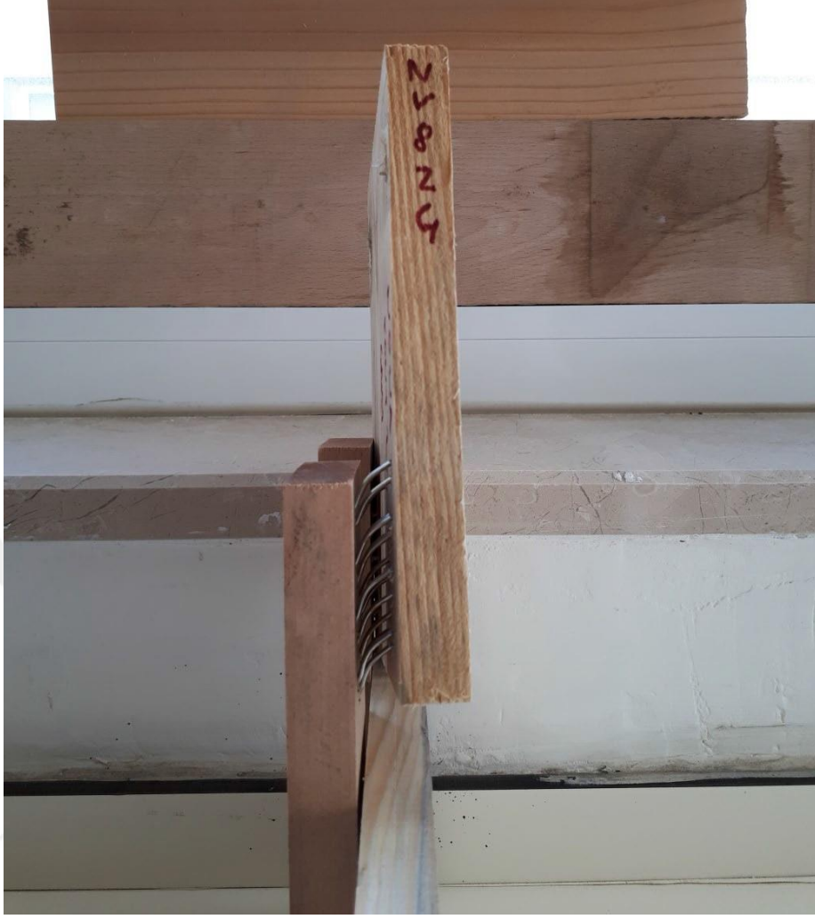
Şekil 21. Zımbaların devirli yük altında koparak ağaç malzemedен çıkması
