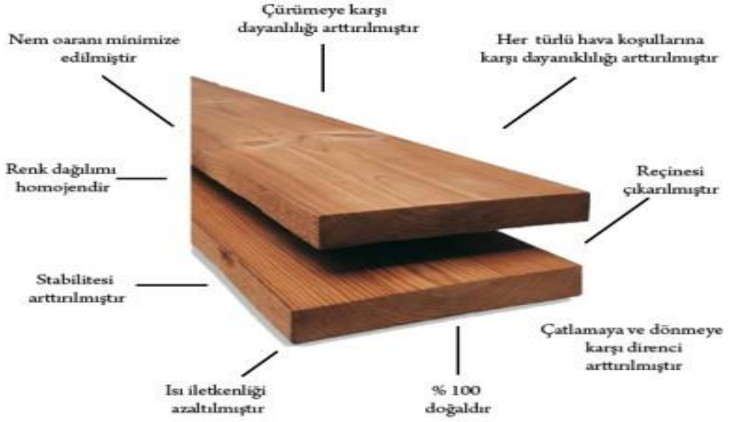
Şekil 2. ThermoWood'un ahşaba kazandırdığı üstün özellikler (URL-2, 2020).
