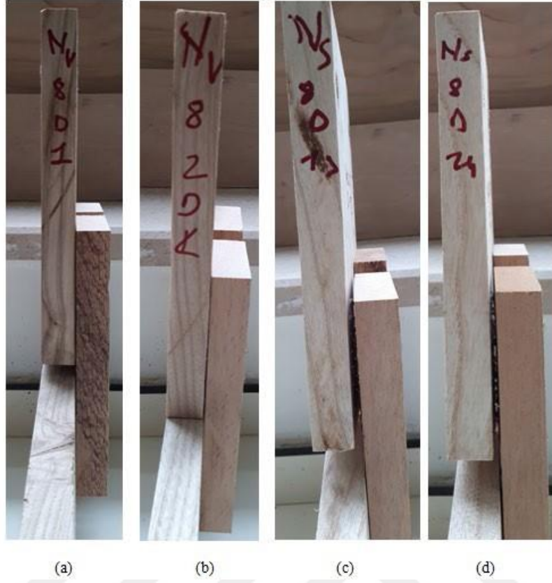
Şekil 28. Dişbudak kontrol örneklerinden oluşturulmuş çift sıra 6 zımbalı birleştirme yerlerine ait ayrılma biçimlerinin önden görünüşleri a) 1 nolu, b) 2 nolu, c) 3 nolu, d) 4 nolu birleştirme yerleri
