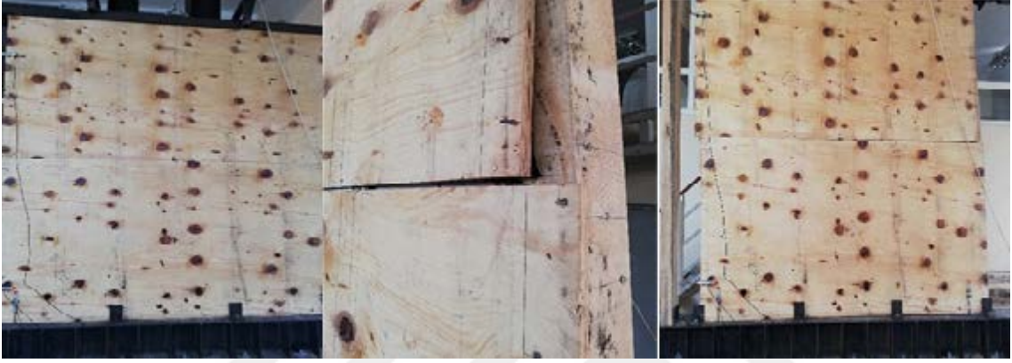
Şekil 36. 5. Duvarda oluşan hasar görünümleri
