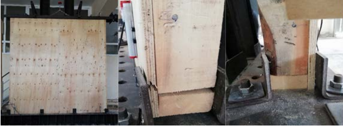
Şekil 34. 12. Duvarda oluşan hasar görünümleri
