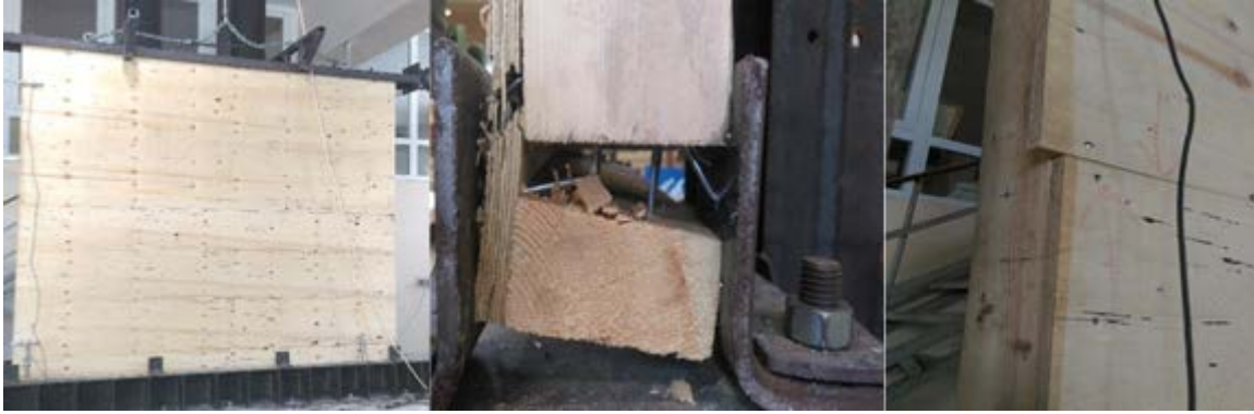
Şekil 35. 15. Duvarda oluşan hasar görünümleri
