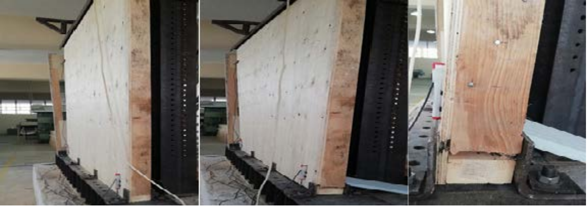
Şekil 39. 10. Duvarda oluşan hasar görünümleri
