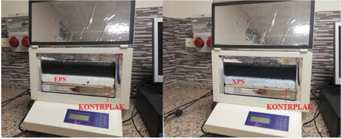
Şekil 19. Oluşturulan ölçüm gruplarının ısı iletkenlik cihazına yerleştirilmesi
