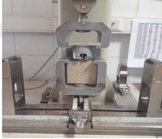
Şekil 56. Vida tutma direnci testi düzeneği
