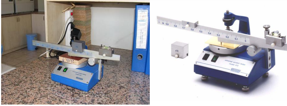
Şekil 59. Çizilme test cihazı ve deneme örneği
