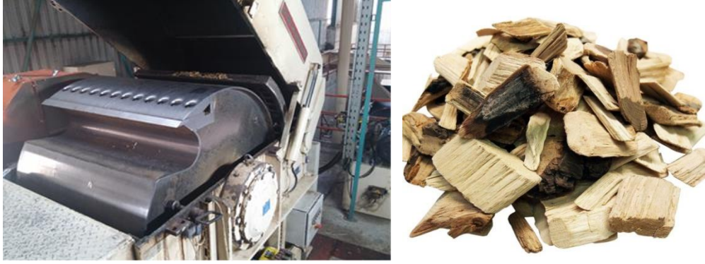
Şekil 11. Silindirik kaba yongalama makineleri, bıçak topu ve cipsler ( pallman pht 500x1050)
