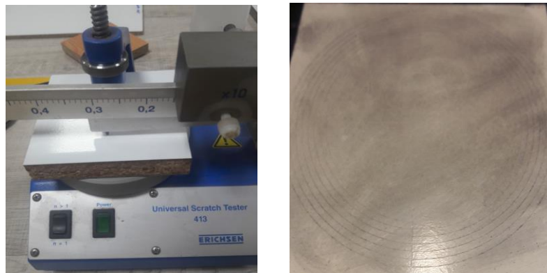
Şekil 60. Çizilme testi deney örneği ve çizgilerin görüntüsü
