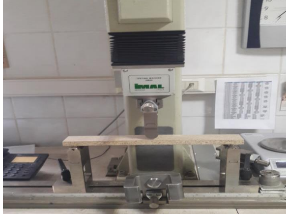
Şekil 54. Eğilme direnci testi düzeneği
