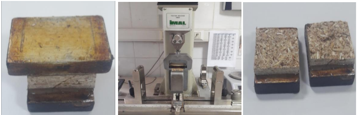
Şekil 55. Yüzeye dik çekme direnci testi düzeneđi
