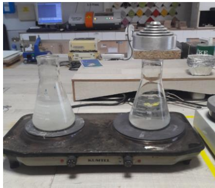
Şekil 65. Su buharına dayanıklılık testi ve deney örnekleri
