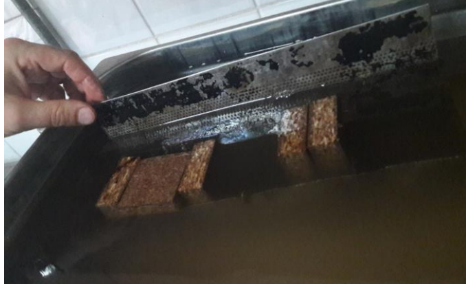
Şekil 52. Su alma testi düzeneği
