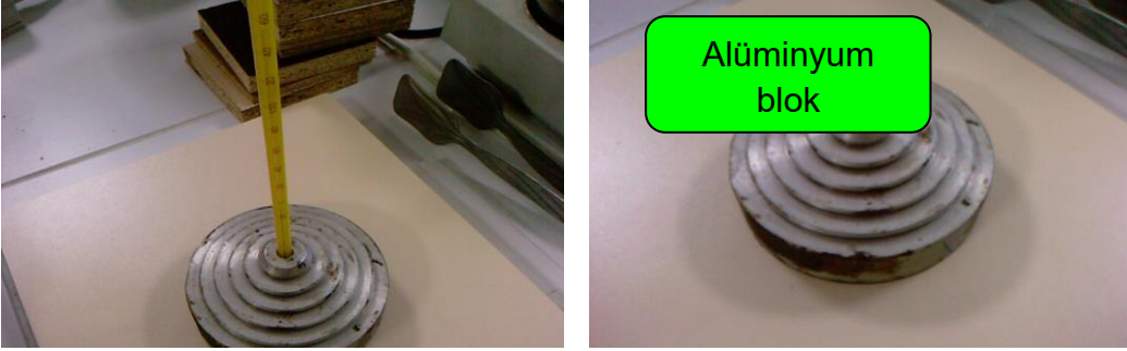
Şekil 67. Sıcak kaplara dayanıklılık testi deney uygulama örneği
