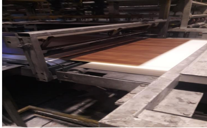
Şekil 37. Melamin pres iyonlama (statikleme) istasyonu
