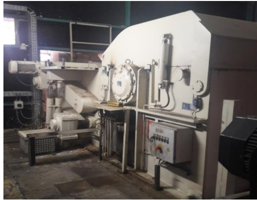
Şekil 10. Samsun fabrikasındaki kaba yongalama makinesi
